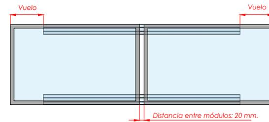
Distribuir los módulos para que su colocación sea simétrica a lo largo del soporte, dejando la misma distancia de sobrante en los extremos. Dejar una separación entre módulos de 20mm.
