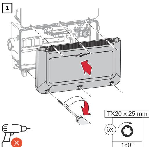
Placer le cache sur la zone de raccordement. Serrer les 6 vis à l'aide d'un tournevis (TX20) et faire un tour de 180° vers la droite.
