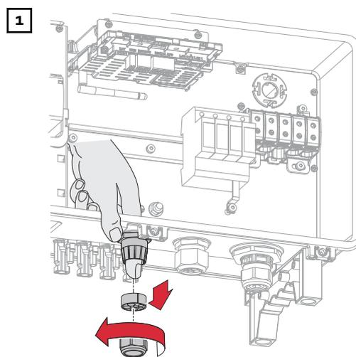
Desserrer l'écrou borgne du raccord de câble et dégager la bague d'étanchéité avec les bouchons obturateurs de l'intérieur de l'appareil.
