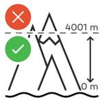
L'onduleur ne doit pas être monté et mis en service sur un site dont l'altitude est supérieure à 4 000 m.
