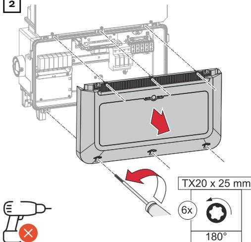
Desserrer les 6 vis du cache de la zone de raccordement à l'aide d'un tournevis (TX20) et faire un tour de 180° vers la gauche.
