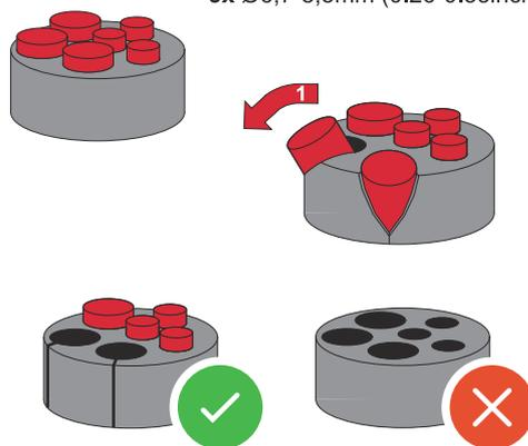
Déployer la bague d'étanchéité à l'endroit où le bouchon obturateur doit être retiré.
