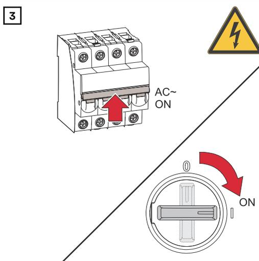
Régler le sectionneur DC en position « On ». Enclencher le système de protection automatique.
