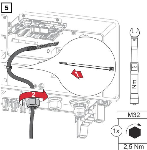
Fixer le câble de données avec un attache-câble sur le capot de protection de la protection contre la surtension DC SPD. Serrer l'écrou borgne du raccord de câble avec un couple de 2,5 à 4 Nm max.
