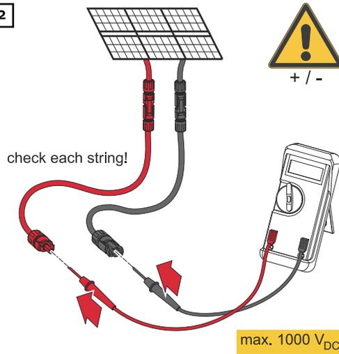
Vérifier la tension et la polarité des câbles DC avec un instrument de mesure approprié.
