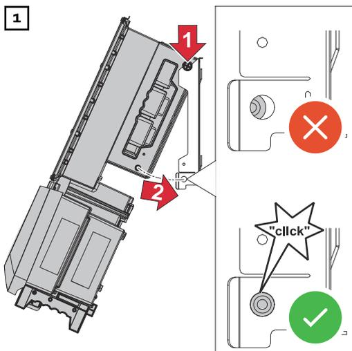
Accrocher par le haut l'onduleur au support de fixation. Les connecteurs doivent être orientés vers le bas.
