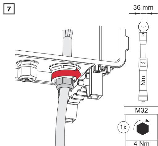
Fixer l'écrou borgne du raccord de câble avec un couple de 6 - 7 Nm.
