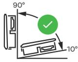
L'onduleur peut être monté à l'horizontale ou sur une surface en biais.
