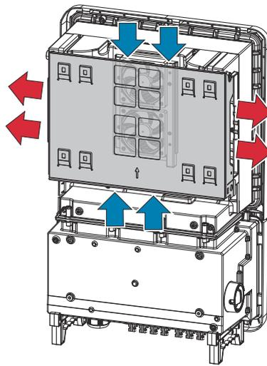
L'air ambiant est aspiré par le ventilateur sur la face supérieure et inférieure puis est soufflé sur les côtés de l'appareil. L'évacuation uniforme de la chaleur permet l'installation de plusieurs onduleurs les uns à côté des autres.
