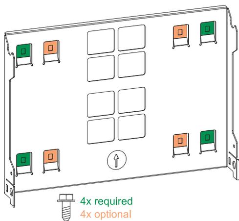
Le support de fixation (schéma) sert également de gabarit de mesure.
