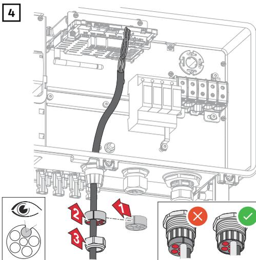
Insérer la bague d'étanchéité entre l'écrou borgne et l'ouverture du boîtier. Enfoncer le câble de données dans le guide-câble du joint. Enfoncer ensuite le joint jusqu'au bord inférieur du raccord de câble.
