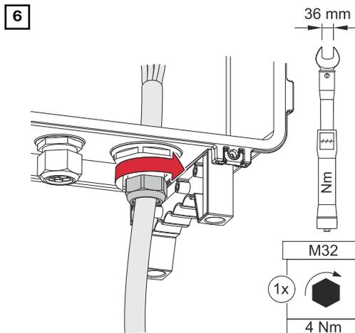
Fixer l'écrou borgne du raccord de câble avec un couple de 6 - 7 Nm.
