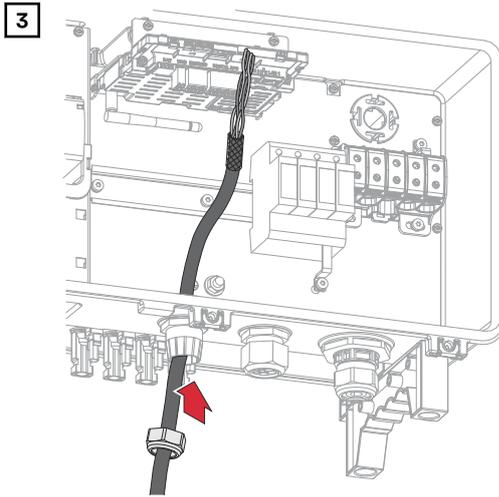
Faire d'abord passer le câble de données par l'écrou borgne du raccord de câble, puis par l'ouverture du boîtier.
