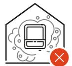
En principe, l'onduleur est étanche à la poussière (IP 66). Cependant, dans les zones avec de grandes accumulations de poussières, des poussières peuvent se déposer sur les surfaces de refroidissement et ainsi entraver la performance thermique. Dans ce cas, il est nécessaire d'effectuer un nettoyage régulier. Il n'est donc pas recommandé d'effectuer un montage dans des pièces ou des environnements avec un dégagement de poussière important.
