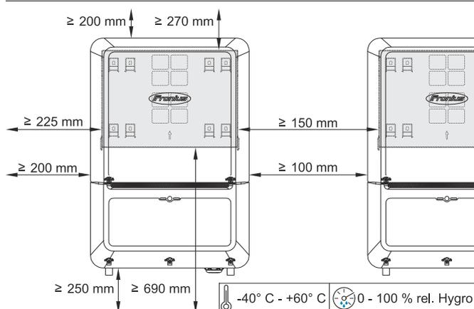
Installation uniquement sur un support solide et non inflammable.
