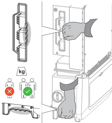
Des poignées sont intégrées sur les côtés de l'onduleur pour faciliter le levage et l'accrochage.
