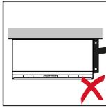
L'onduleur ne doit pas être monté au plafond.
