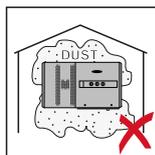
L'onduleur est étanche à la poussière (IP 65). Cependant, dans les zones avec de grandes accumulations de poussières, les surfaces de refroidissement peuvent s'encrasser et ainsi entraver la performance thermique. Dans ce cas, il est nécessaire d'effectuer un nettoyage régulier. Il n'est donc pas recommandé d'effectuer un montage dans des pièces ou des environnements avec un dégagement de poussière important.
