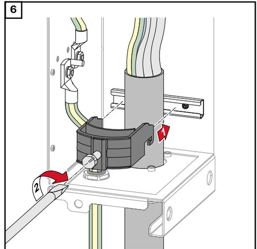
Fixer avec le couple de serrage indiqué par le fabricant de l'anti-traction. L'anti-traction ne fait pas partie de la livraison.
