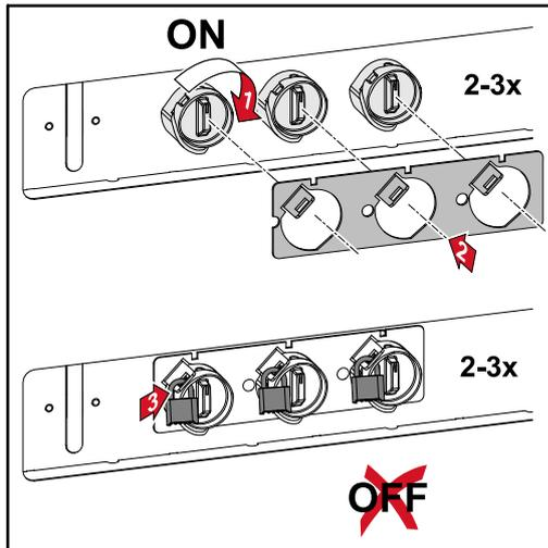
Grâce au verrouillage du sectionneur DC disponible en option, l'onduleur peut être verrouillé pour éviter tout arrêt involontaire.
