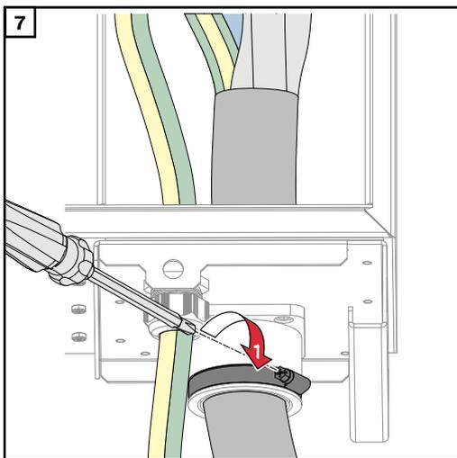
Fixer avec le couple de serrage indiqué par le fabricant
