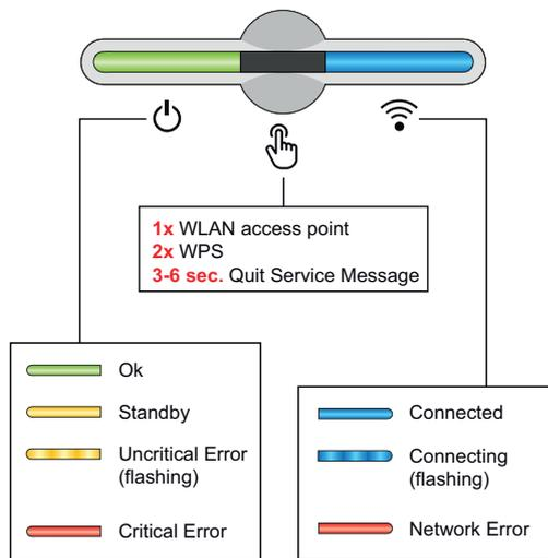
L'état de l'onduleur est indiqué par la LED de fonctionnement. En cas de panne, les différentes étapes doivent être effectuées sur l'application Fronius Solar.web live.
