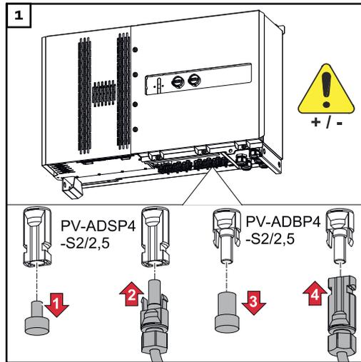
Connecter les câbles photovoltaïques des modules solaires aux connecteurs MC4 conformément à l'étiquette.
