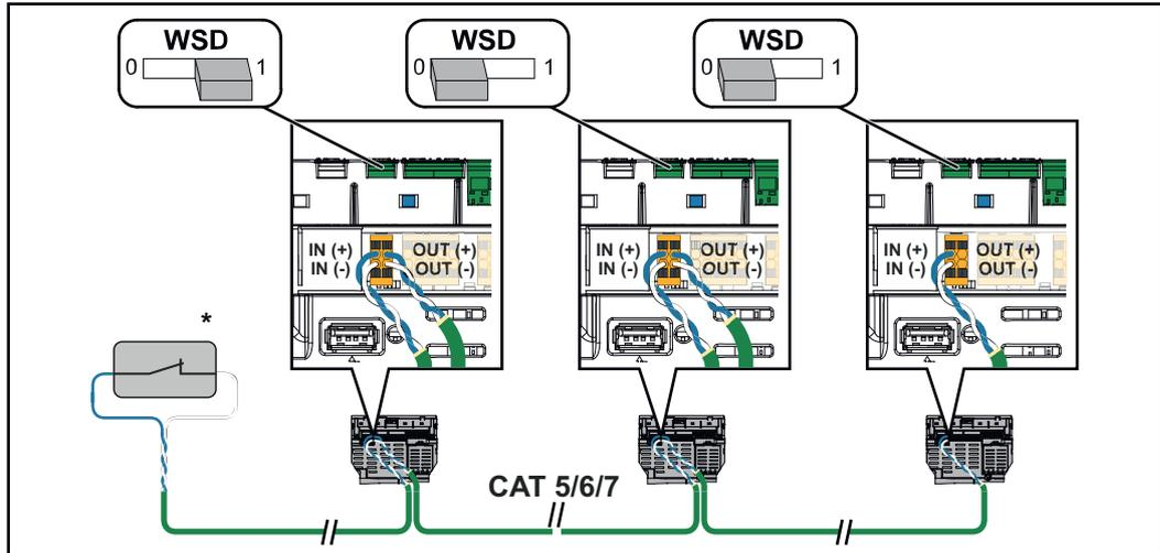
\* Contact sans potentiel du dispositif de déclenchement (par ex. protection centrale du réseau et de l'installation). Si plusieurs contacts sans potentiel sont utilisés dans une chaîne WSD, ils doivent être connectés en série.
