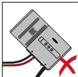
L'onduleur ne doit pas être monté en biais sur un mur vertical ou une colonne.
