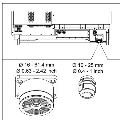
Les diamètres extérieurs de câble suivants sont possibles pour le plus grand modèle :
