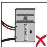
L'onduleur ne doit pas être monté à l'horizontale sur un mur vertical ou une colonne.
