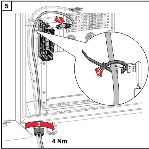
Raccorder le câble de données à la zone de communication de données en formant une boucle et fixer l'écrou borgne avec un couple de 2,5 Nm à 4 Nm.
