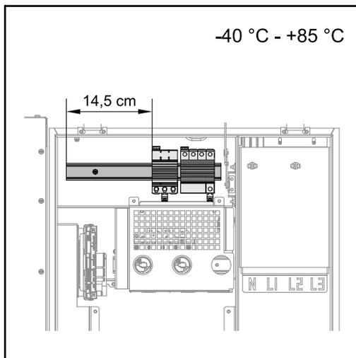
Un emplacement est prévu pour le montage de composants de fournisseurs tiers au-dessus de la zone de raccordement DC. Des composants d'une largeur maximale de 14,5 cm (8 TE) peuvent être montés sur le profilé chapeau. Les composants doivent présenter une résistance à la température de -40 °C à +85 °C.
