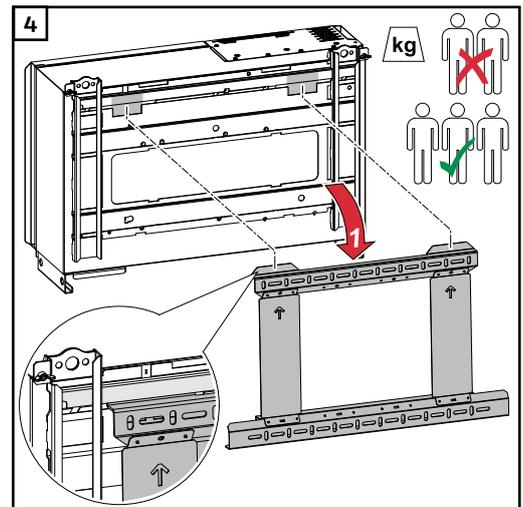
Respecter les réglementations locales en matière de levage de charges lourdes, ou utiliser une grue pour soulever l'appareil au niveau des anneaux de levage.
