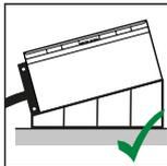
L'onduleur doit avoir une inclinaison minimale de 3° en position de montage horizontale, afin que l'eau puisse s'écouler. Le montage des Floor Racks en option est recommandé. Les Floor Racks ne peuvent être utilisés que dans une position de 0 à 45°.
