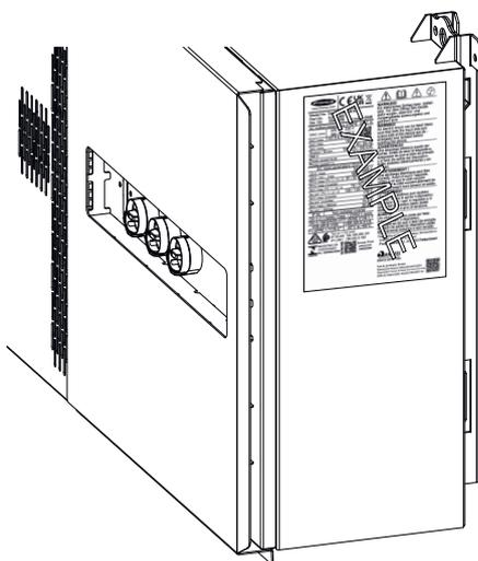
Un numéro à 4 chiffres (coded production date) est imprimé tout en bas de la plaque signalétique. Il est possible de calculer la date de production de l'appareil à partir de ce numéro. Il suffit de soustraire le chiffre 11 aux deux premiers chiffres pour obtenir l'année de production. Les deux derniers chiffres représentent la semaine calendaire au cours de laquelle l'appareil a été produit.
