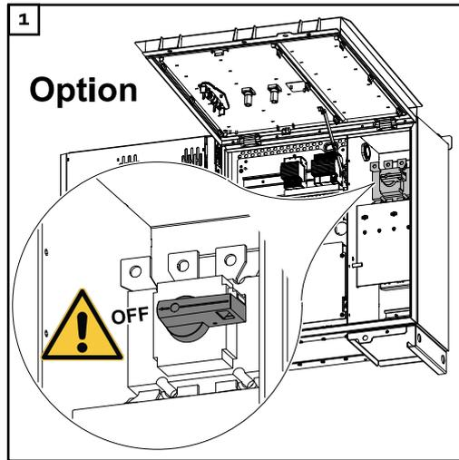
**Raccorder l'onduleur au réseau électrique public - Singlecore**
