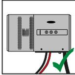
L'onduleur peut être monté à la verticale sur un mur vertical. Les Floor Racks en option ne doivent pas être utilisés pour un montage vertical.
