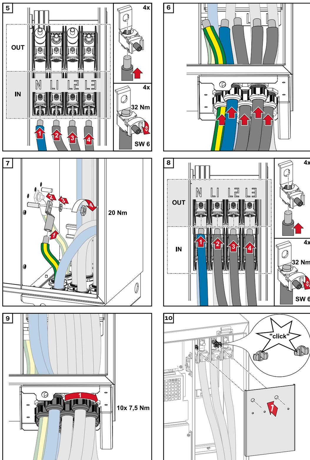
**Raccorder les câbles avec cosse de câble**
