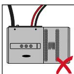
L'onduleur ne doit pas être monté avec les connecteurs vers le haut sur un mur vertical ou une colonne.
