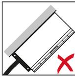
L'onduleur ne doit pas être monté en porte-à-faux avec les connecteurs vers le bas.
