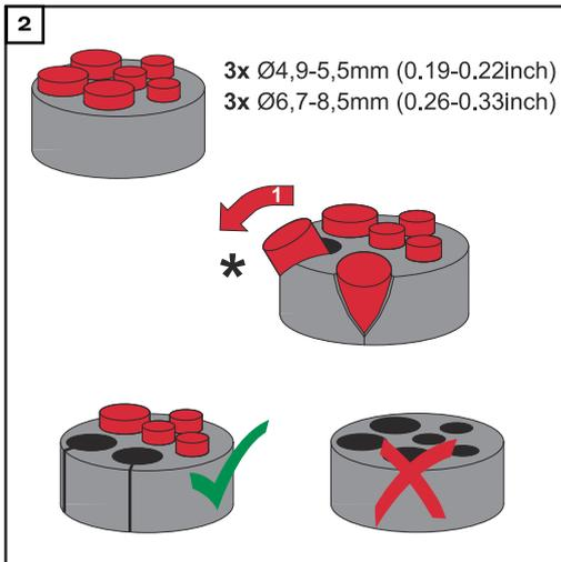
Déployer la bague d'étanchéité à l'endroit où le bouchon obturateur doit être retiré.
