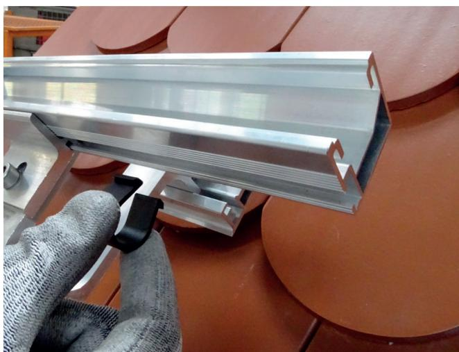
Omega Kabel-Clip zusammendrücken und mit der offenen Seite an der gewünschten Stelle in die Anbindungsöffnung der Montageschiene einsetzen.
