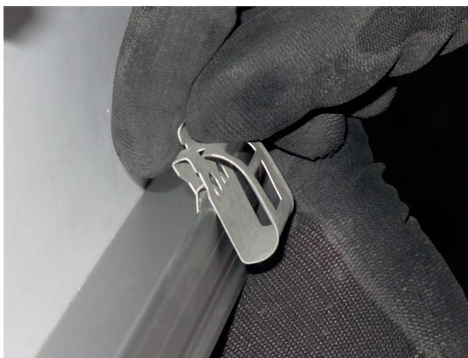
Cable Routing Clip mit der engen Rastöffnung an den inneren Flansch der Modulrahmen schieben.
