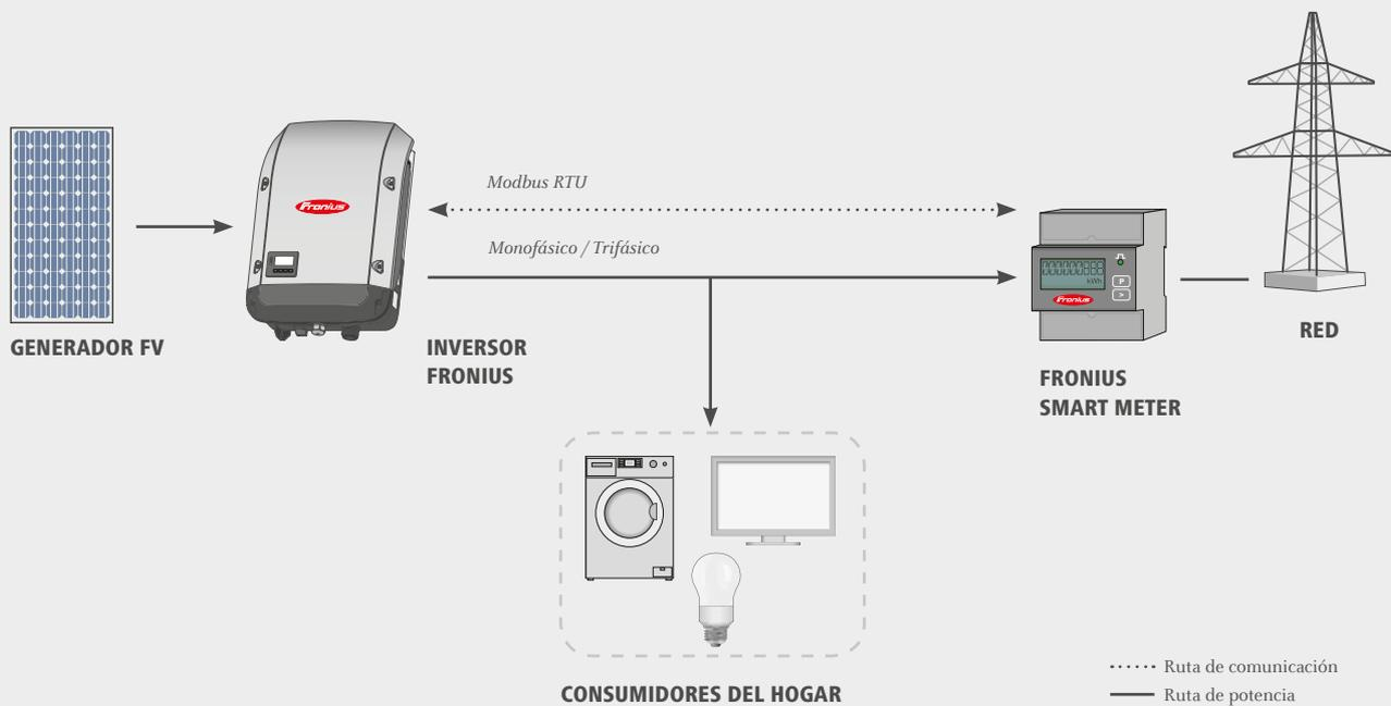
/ El Fronius Smart Meter es compatible con todos los inversores con un Interface RS485 (Modbus RTU). El Fronius Smart Meter funciona en paralelo con el Datamanager 2.0 para los inversores Fronius IG Plus. El Fronius Smart Meter puede ser instalado en cualquier momento junto con el Fronius Datamanager 2.0, después de la puesta en marcha de un inversor.
