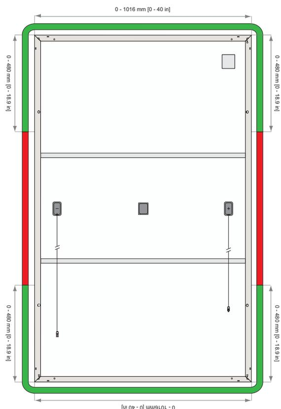
Fig. 23: Zonas de instalación de dispositivos MLPE en la serie REC Alpha 72
