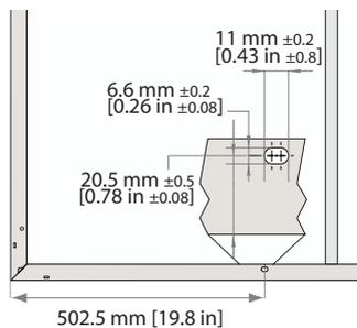
Fig. 13: Especificaciones de dispositivos para los orificios de montaje
