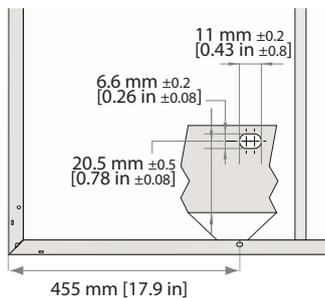
Fig. 12: Orificios de montaje: Serie REC Alpha 72
