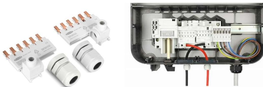
/ Das DC Connector Kit ermöglicht das Bügeln der beiden Eingänge bei MPP-Strömen über 35 A und einem Kabelquerschnitt über 16 mm<sup>2</sup>, zum Beispiel bei Verwendung einer DC Box. Mit dem Einsatz des DC Connector Kits kann ein Querschnitt von 6 mm<sup>2</sup> bis 25 mm<sup>2</sup> angeschlossen werden. Die Klemme ist berührsicher aufgebaut. Das DC Connector Kit eignet sich speziell zur Verwendung mit Fronius Symo 10.0 – 20.0 kW und Fronius Eco Wechselrichtern.
