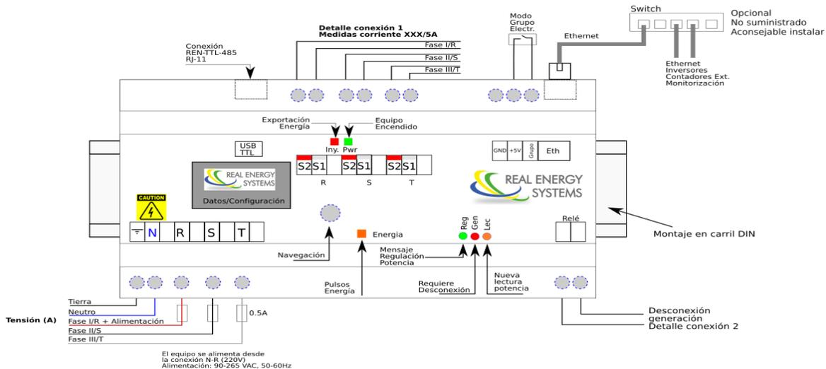
Ilustración 1: Esquema de conexiones y leyenda de indicadores
