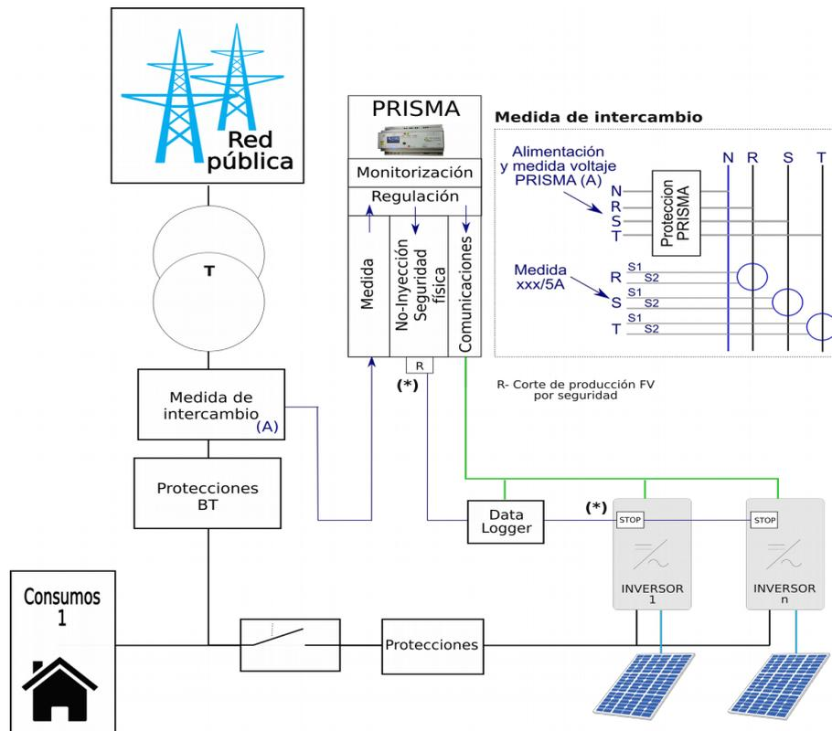
Ilustración 2: Control físico de conexión a la red
