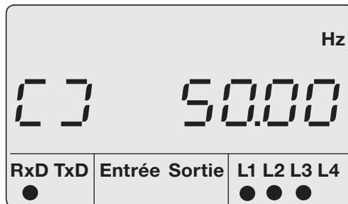
Fig. 19.2 Exemple d'affichage pour le champ magnétique rotatif et la fréquence.
