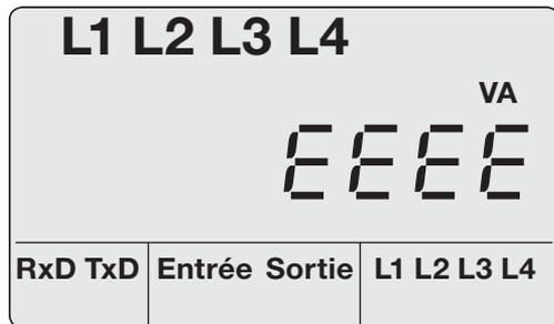
*Fig. Affichage des valeurs mesurées avec dépassement de la plage de mesure.*
