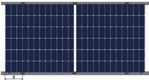
Instalación de módulo sin marco con accesorios de fijación en lados largos. (longitud de la abrazadera =150mm)
