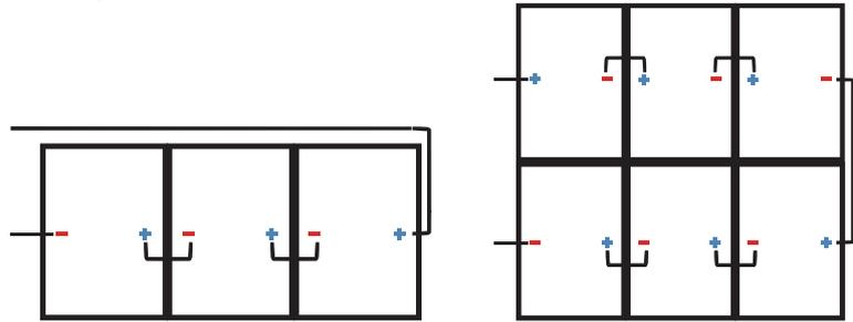
Instalación horizontal: la longitud de una sola línea de 60 componentes debe ser  $\geq 1.2m$ , la longitud de una sola línea de 72 componentes debe ser  $\geq 1.4m$ , y la longitud de una sola línea de 78 componentes debe ser  $\geq 1.5m$
