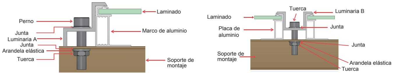
Figura 5 Diagrama de instalación del accesorio de componente de un solo lado
