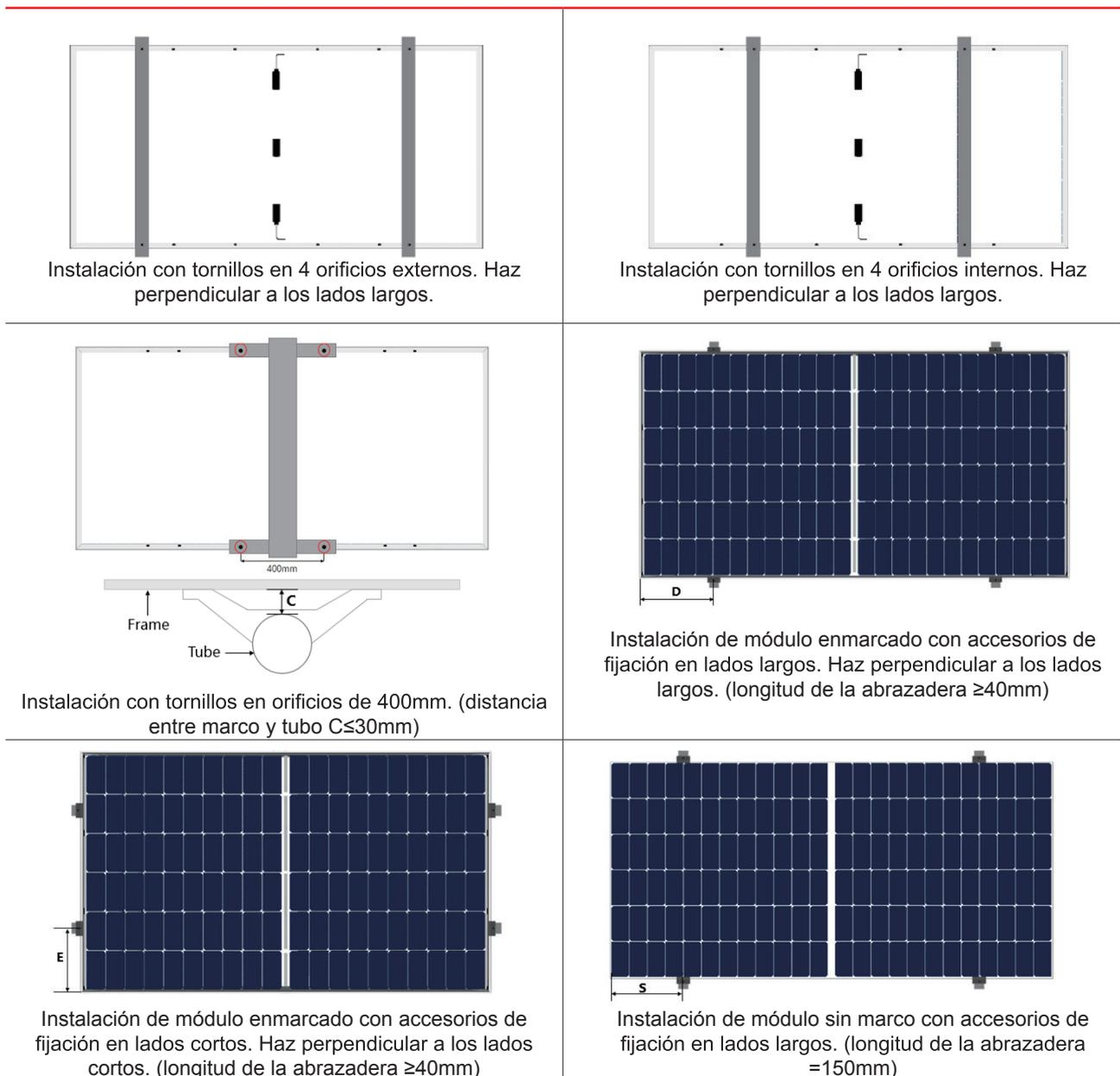
Figura 6 Diagrama de instalación de componentes de un solo lado
