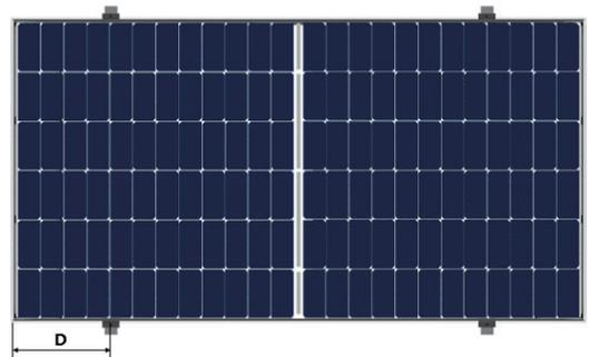
Instalación de módulo enmarcado con accesorios de fijación en lados largos. (haz perpendicular a los lados largos)(longitud de la abrazadera  $\geq$ 40mm)
