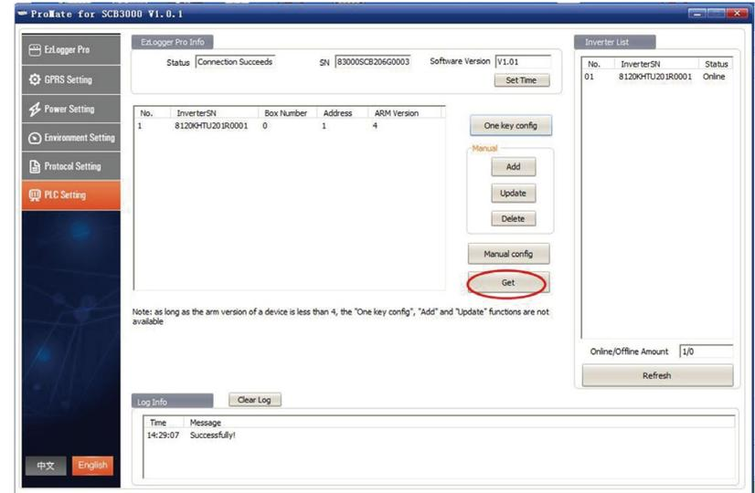
(d) Manually configure the inverter address
