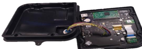
Volta a ligar o cabo se tiver sido desligado ao abrir a tampa.
