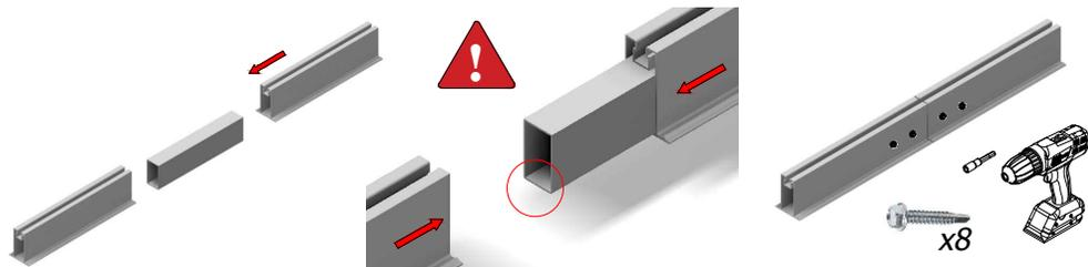
Introducir la unión UG2 dentro de los perfiles G2, quedando la mitad de la unión dentro de cada perfil y fijar con 8 autotaladrantes, 4 a cada lado del perfil.
