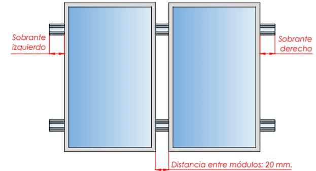
Dejar una separación entre módulos de 20 mm para poner el presor central que fijará los módulos al perfil.
