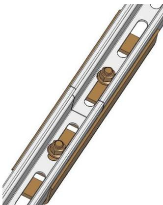
Unir bien los extremos de los raíles. Colocar el conector de raíl en el centro y unirlo al raíl utilizando los tornillos de fijación incluidos en el set. El conector y el número de tornillos dependen del raíl (VM 3).
