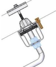
Avant de procéder au montage du panneau, il est nécessaire de monter les sécurités anti-glissement au niveau des trous du cadre au-dessus de la position inférieure des rails. Il est recommandé d'utiliser la sécurité anti-glissement sur tous les panneaux afin de faciliter le montage des panneaux.
