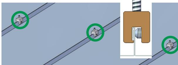
Klemme auf den Falz aufsetzen und mit der Madenschraube am Falz befestigen. Die Klemmen dürfen nicht auf oder im Bereich von Blechhaften montiert werden!
