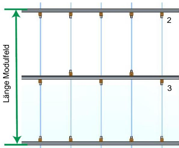
Bei der obersten und untersten Einlegeschiene des Modulfeldes wird das Stehfalzklemmen-Set ES jeweils auf der Innenseite montiert (1, 2), an den mittleren Einlegeschiene sind die Stehfalzklemmen-Sets ES abwechselnd oben und unten am Halteflansch anzubringen (3).
