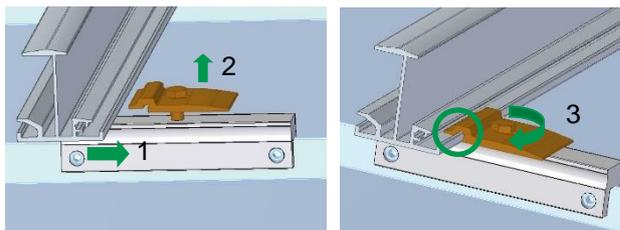
Einlegeschiene auf Stehfalzklemme 150 ES M8 anlegen, gegen Kreuzschienenverbinder ES schieben (1) und in Halteflansch eingehängen (2), Schiene ausrichten und Sechskantschraube anziehen (3).
