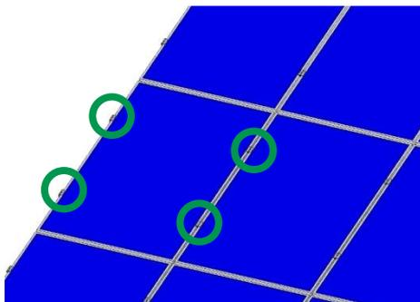
Danach sind die Module mit Endklemmen und Mittelklemmen an den Schienen zu befestigen.
