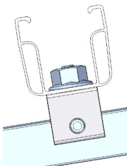
C-Schiene auf die Klemme auflegen und Schiene mit der Sperrzahnmutter anziehen.
