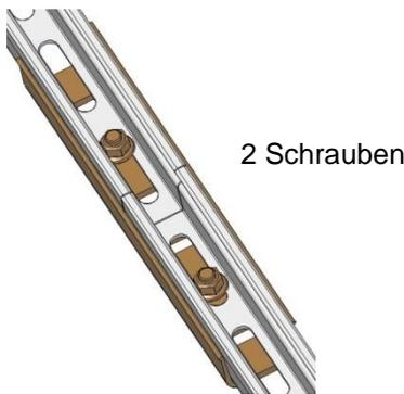
Schienenenden dicht stoßen, Schienenverbinder mittig anlegen und über die im Set enthaltenen Befestigungsschrauben mit der Schiene verbinden. Alternativ kann das Schienenverbinder-Set C47 S eingesetzt werden (MV 3.1).
