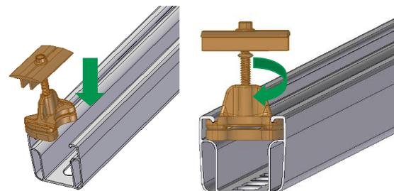
Mittelklemmen bzw. Endklemmen an der Klemmstelle von oben in die Schienenkammer einführen. Anschließend die Schienenmutter in der Schiene drehen und Modulklemmen an den Modulrahmen anschieben.
