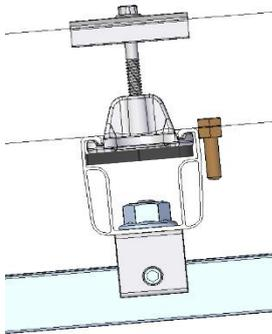
Vor der Modulmontage sind über der unteren Schienenlage die Abrutschsicherungen an den Rahmenbohrungen zu montieren (MV 4).
