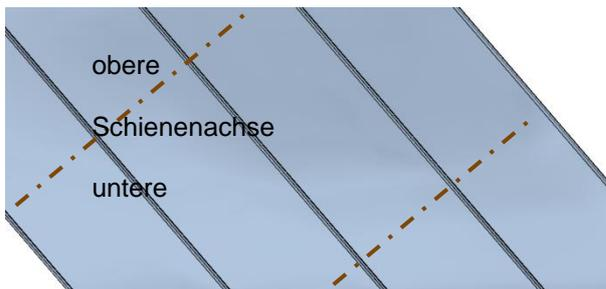
Die Klemmen sind mittig unter den C-Schienen zu montieren, dazu ist die Achse vorab auf der Eindeckung anzuzeichnen bzw. mit der Schnur zu kennzeichnen. Pro Modulreihe sind zwei Schienenachsen anzuordnen.
