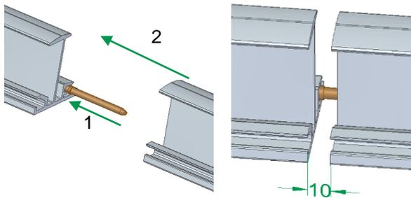
Verbinder in das fixierte Schienenstück in den Schraubkanal einschieben (1), dann das lose Schienenstück mit dem Schraubkanal auf den Verbinder mit 10 mm Spalt zwischen den Schienenenden aufschieben, danach das zweite Schienenstück befestigen.
