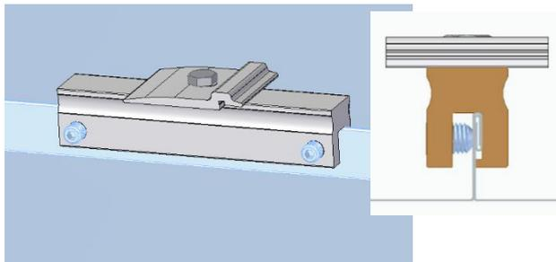
Klemme auf den Falz aufsetzen und mit beiden Madenschrauben am Falz befestigen. Die Klemmen dürfen nicht auf oder im Bereich von Blechflanken montiert werden!
