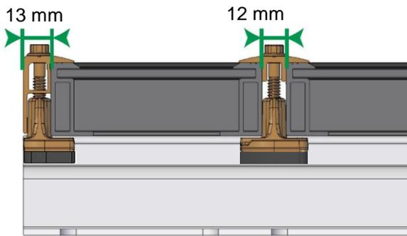
Endklemmenmontage bündig mit dem Schienenende möglich.
