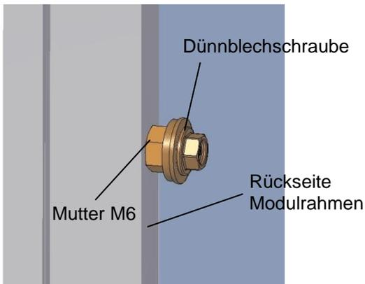
Mutter über die Schraube schieben und Dünnschraube ohne Vorbohren in den Modulrahmen eindrehen.
