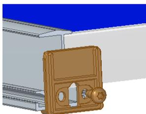
Randanschlag am Ende einer Modulreihe an jeder Einlegeschiene mit einer Blechschraube im Schraubkanal montieren.
