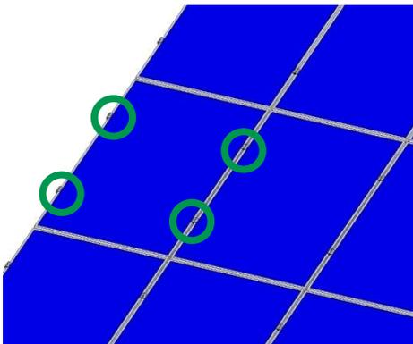
Danach sind die Module mit End- und Mittelklemmen an den Schienen zu befestigen – dies gilt sinngemäß auch für die Modulquermontage.
