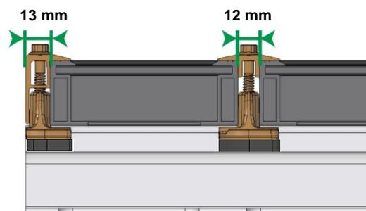
Endklemmenmontage bündig mit dem Schienenende möglich.
