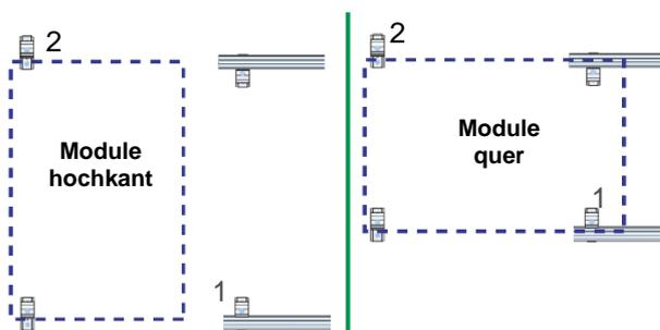
Die Kurzprofile mit Länge 125 mm sind an der obersten und untersten Einlegeschiene jeweils auf der Innenseite (1), an den mittleren Einlegeschiene abwechselnd oben und unten (2) gemäß statischer Berechnung auf den Hochsicken zu platzieren und mit der erforderlichen Anzahl Befestigungsmittel abzuschrauben.
