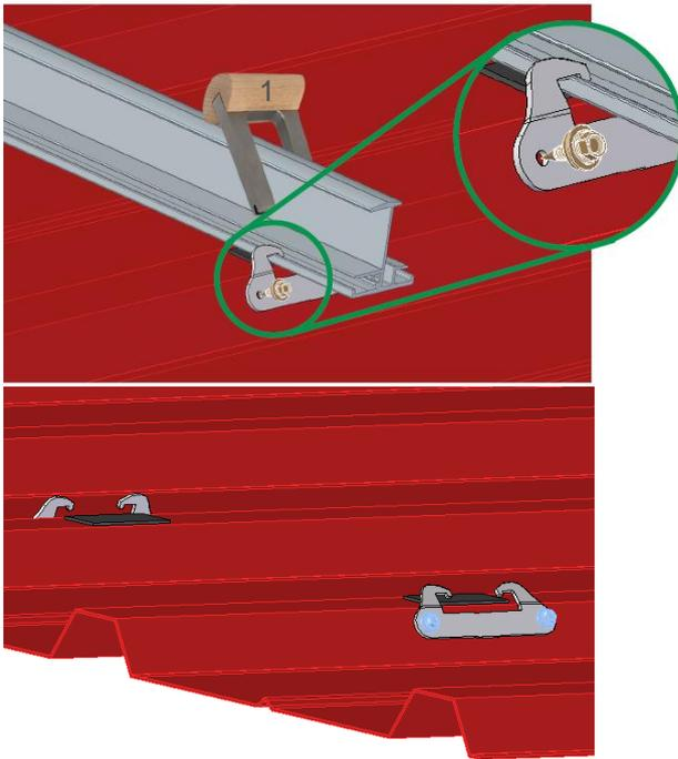
Trapez-Klammer mit Hilfe des Montagewerkzeugs (1) in Neigung der Hochsicke mit Druck nach unten auf der Einlegeschiene positionieren. Trapez-Klammer mit zwei Dünnblechschrauben ohne Vorbohren seitlich in die Hochsicke einschrauben.
