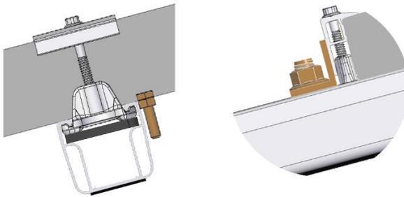
Vor der Modulmontage hochkant sind über der unteren Schienenlage die Abrutschsicherungen an den Rahmenbohrungen zu montieren (MV 3). Zur Erleichterung der Modulmontage wird der Einsatz der Abrutschsicherung an allen Modulen empfohlen. Bei der Modulquermontage sind an der untersten Modulreihe Abrutschsicherung-Sets einzusetzen.
