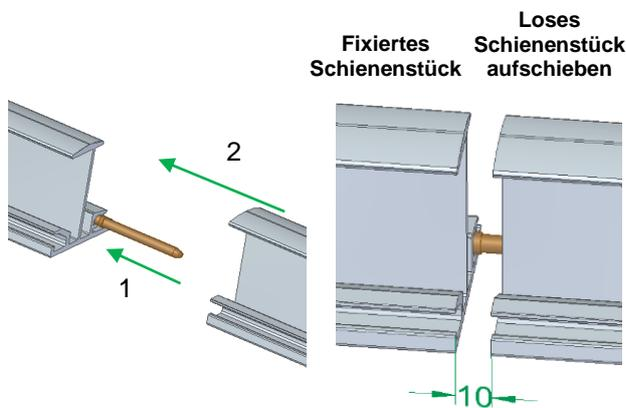
Verbinder in das fixierte Schienenstück in den Schraubkanal einschieben (1), dann das lose Schienenstück mit dem Schraubkanal auf den Verbinder mit 10 mm Spalt zwischen den Schienenenden aufschieben, danach das zweite Schienenstück befestigen.
