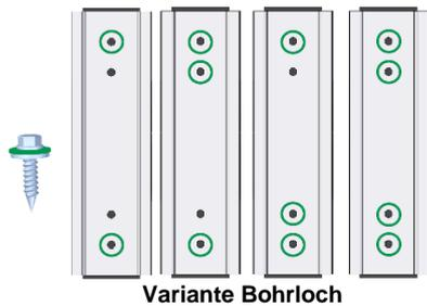
Die Anzahl und Anordnung erforderlicher Befestigungsmittel erfolgt gemäß statischer Berechnung mit den dargestellten Befestigungsmitteln gemäß nebenstehender Zeichnung.
