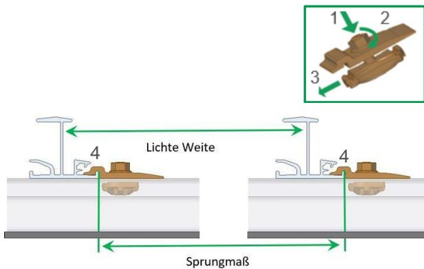
Kreuzschienenverbinder-Set C ES von oben in Schienennut einführen (1), Mutter um 90° verdrehen (2) und Bauteil gegen die Einlegeschiene schieben (3), so dass das Kreuzschienenverbinder-Set C ES sich mit dem Halteflansch verriegelt (4).
