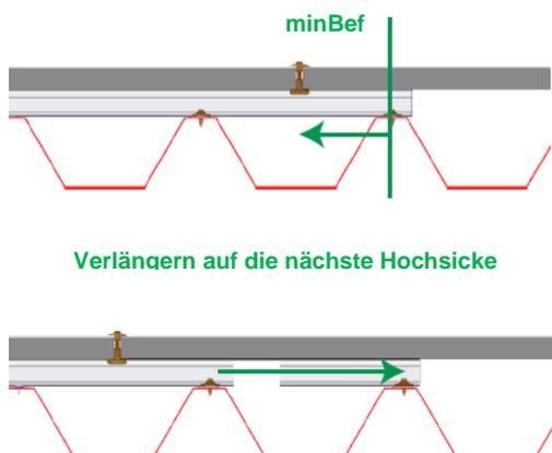
Der Abstand (minBef.) zwischen Mittelklemme und nächstem Befestigungsmittel gemäß statischer Berechnung darf nicht unterschritten werden, bei Nichteinhaltung muss zur nächsten Hochsicke verlängert werden – daraus ergibt sich die Schienenlänge min oder max.
