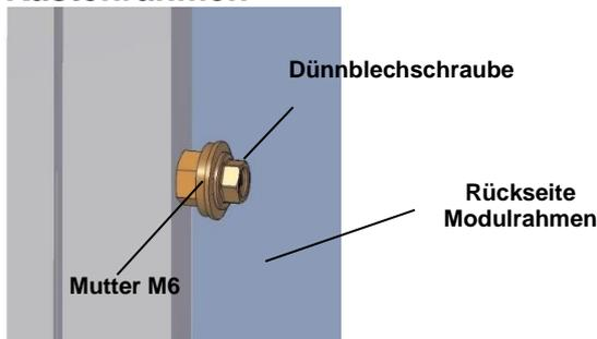
Mutter über die Schraube schieben und Dünblechschraube ohne Vorbohren in den Modulrahmen eindrehen.
