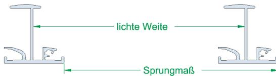
Montageachsen der Einlegeschiene in Abhängigkeit von der Modulausrichtung – hochkant oder quer – auf den Trapezblechhoch-sicken markieren.
