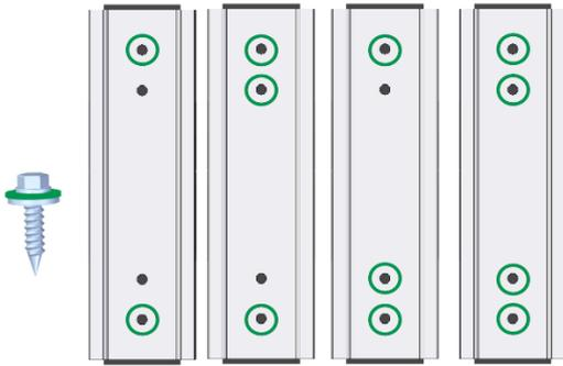
Die statische Berechnung in der Anlagenplanung legt die Anzahl der erforderlichen Befestigungsmittel für die Modulquermontage fest.
