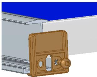
Radanschlag am Ende einer Modulreihe an jeder Einlegeschiene mit einer Blechschraube im Schraubkanal montieren.
