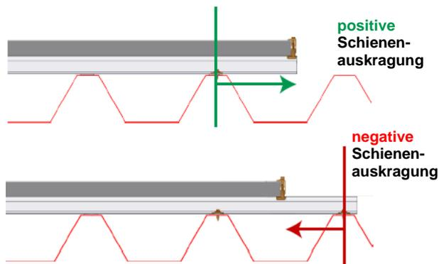
Schienenanskragungen sind nur an Randmodulen möglich. Die Länge der Schienenstücke ist abhängig von der Lage des Klemmpunkts zum nächsten Befestigungsmittel. Die in der statischen Berechnung ermittelte Schienenlänge (min/max) ist so auf das Dach zu übertragen.
