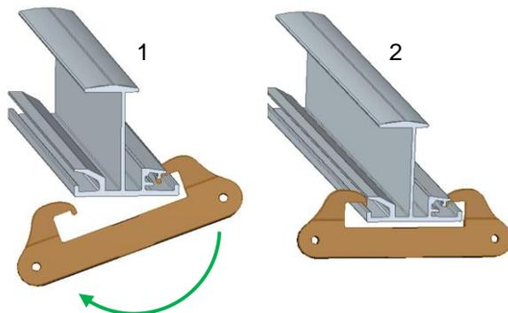
Einlegeschiene auf die EPDM-Streifen auflegen, 10mm Spalt am Schienenstoß einhalten, Trapez-Klammer-Set ES einseitig in die Schiene einhängen, unter der Schiene durchführen (1) und auf der anderen Seite einhängen (2). Es müssen beide Seiten der Trapez-Klammer-Set ES in der Einlegeschiene eingehängt sein.
