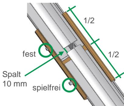
Schienenverbinder über montierte Schiene mittig schieben und ersten Gewindestift fest anziehen. Anzuschließende Schiene in den Verbinder einschieben, Spalt zwischen den Schienen 10 mm, zweiten Gewindestift spielfrei anziehen.
