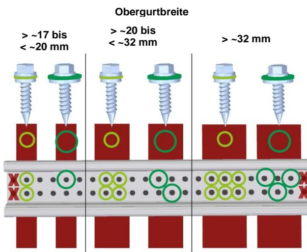
Die statische Berechnung in der Anlagenplanung legt die Anzahl und Anordnung der erforderlichen Befestigungsmittel für die Modulhochkantmontage fest.
