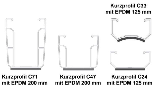
Zur Verbesserung der Modulhinterlüftung kann die Modulquermontage mit dem Kurzprofil C 47 bzw. C71 erfolgen, die Montageschritte sind in derselben Reihenfolge, wie in Kapitel 5.1 beschrieben, durchzuführen.
