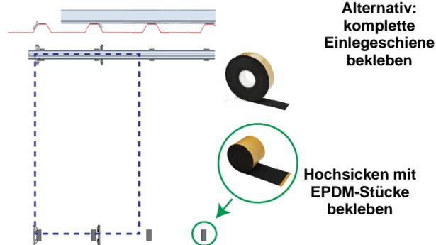
Aufkleben der EPDM-Stücke auf jeder Hochsicke unter den Einlegeschiene. Alternativ kann bei kleinen Hochsickenabständen auch die Einlegeschiene mit einem EPDM-Band beklebt werden.
