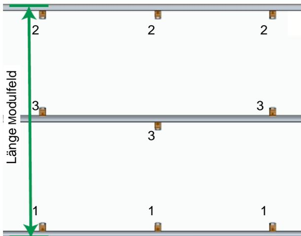
Bei der obersten und untersten Einlegeschiene des Modulfeldes wird das Kreuzschienenverbinder-Set C ES M8 jeweils auf der Innenseite montiert (1, 2), an den mittleren Einlegeschiene sind die Kreuzschienenverbinder-Set C ES M8 abwechselnd oben und unten am Halteflansch anzubringen (3)
