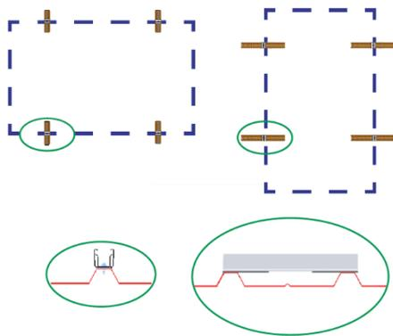
Montageposition der Kurzprofile in Abhängigkeit von der Modulausrichtung – hochkant oder quer, rechtwinklig oder auf der Hochsicke – und der vom Modulhersteller vorgegebenen Klemmbereiche auf den Trapezblechhochsicken markieren. Es ist ein Spalt von mind. 10 mm zwischen den Modulen an der kurzen Rahmenseite einzuhalten.
