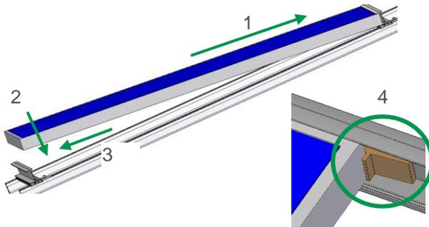
Modul auf die obere Einlegeschiene aufsetzen und nach oben schieben (1). Danach das Modul auf die untere Einlegeschiene absetzen (2) und nach unten gegen die Einlegeschiene schieben (3). Folgemodule nach demselben Prinzip montieren, der Spalt zwischen den Modulen muss mind. 3 mm betragen.
