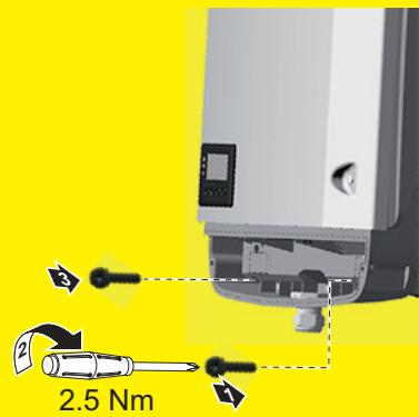
Zet de inverter met behulp van bevestigingsschroeven altijd stevig vast aan de muursteun. Houd u hierbij aan het aanhaalmoment dat in de gebruiksaanwijzing is aangegeven. Neem de inverter uitsluitend met vastgedraaide bevestigingsschroeven in bedrijf.
