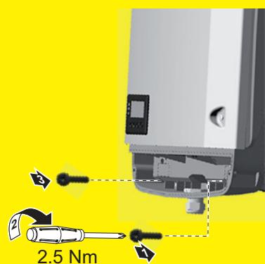
Atornillar el inversor siempre mediante los tornillos de fijación, según el par indicado en el manual de instrucciones, firmemente al soporte mural.
