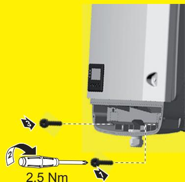
Az invertert minden csavarozza rögzítőcsavarokkal, a kezelési útmutatóban megadott nyomatékkal a fali tartóhoz.
