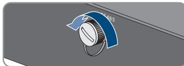
5. Insérez le connecteur M12 dans la prise du port de communication RS485 et serrez-le. Orientez le connecteur de sorte que l'ergot de guidage de la prise de l'onduleur s'insère dans la rainure de guidage du connecteur.
