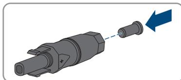
14. Insérez les connecteurs DC avec les bouchons d'étanchéité dans les entrées DC correspondantes de l'onduleur.
