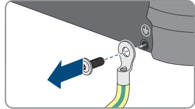
14. Dévissez les vis à tête bombée M5 x 12 gauche et droite de fixation de l'onduleur au support mural (TX25).
