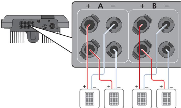
Figure 10 : Vue d'ensemble du raccordement en fonctionnement normal
