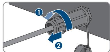
6. Dévissez la douille fileté du filetage de la prise réseau sur l'onduleur et retirez-la.
