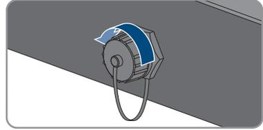
3. Appuyez sur le manchon support de câble pour le retirer de la douille filetée.
