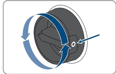
3. Si la sécurisation de l'interrupteur-sectionneur DC est requise par les directives locales en vigueur, sécurisez-le contre toute remise en marche à l'aide d'un cadenas adapté.
