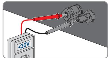
9. Vérifiez l'absence de tension au niveau des entrées DC entre le pôle positif et la terre et le pôle négatif et la terre avec un multimètre adapté.
