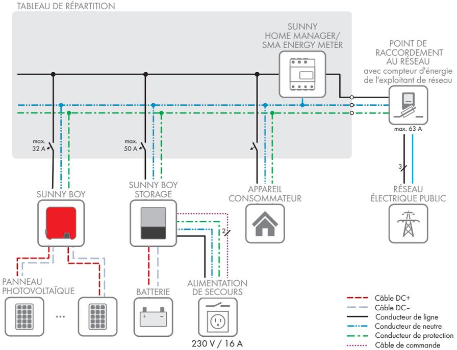
Figure 4 : Vue d'ensemble du câblage (exemple)
