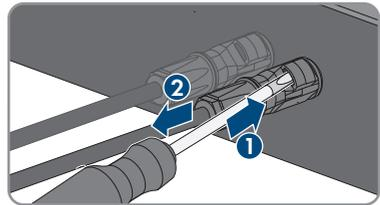
2. Desserrez l'écrou-raccord du connecteur DC.
