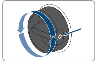
4. Si la sécurisation de l'interrupteur-sectionneur DC est requise par les directives locales en vigueur, sécurisez-le contre toute remise en marche à l'aide d'un cadenas adapté.
