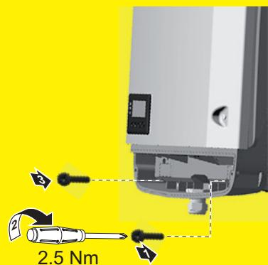
Prevederile producătorului pentru conectare, instalare și exploatare trebuie respectate obligatoriu. Efectuați cu atenție toate lucrările de instalare și conectare urmând prevederile și normele, pentru a reduce la minimum potențialul de pericol. Cuplurile de strângere de la respectivele puncte de prindere sunt indicate în manualele de utilizare ale aparatelor.
