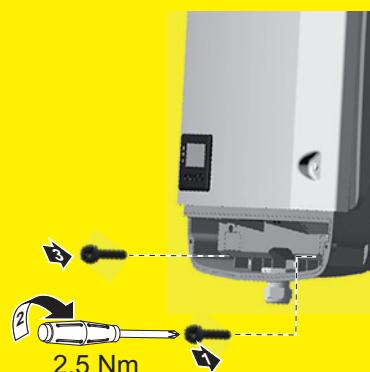
Należy bezwzględnie przestrzegać instrukcji producenta dotyczących podłączenia, instalacji i eksploatacji. Wszelkie instalacje i połączenia należy wykonać dokładnie, zgodnie z założeniami i przepisami, w celu zredukowania do minimum potencjału zagrożenia.
