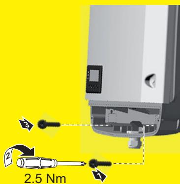
Resulta imprescindible cumplir las indicaciones del fabricante para conexión, instalación y servicio. Realizar todas las instalaciones y conexiones según las especificaciones y prescripciones para reducir al mínimo el potencial de peligro. Los pares de apriete de los correspondientes puntos de apriete figuran en el manual de instrucciones o en las instrucciones de instalación de los equipos.
