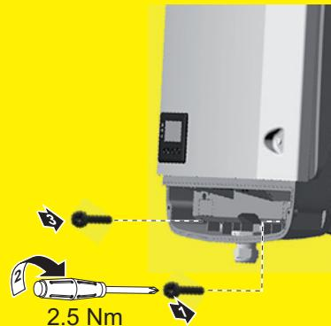
Valmistajan määrittämiä liitännätä-, asennus- ja käyttötietoja täytyy ehdottomasti noudattaa. Tee kaikki asennus- ja liitännätöt huolellisesti ohjeiden ja määräysten mukaan, jotta vaaratilanteilta vältyttäisiin mahdollisimman te-hokkaasti. Noudata kaikissa kiinnityskohdissa laitteiden käyttö- ja asennusohjeissa mainittuja kiristysmoment-teja.
