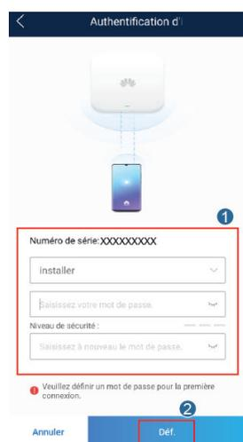
**Étape 4** Définissez les paramètres du routeur et du système de gestion pour mettre en œuvre la gestion à distance.
