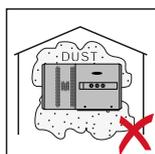
Der Wechselrichter ist staubdicht (IP 65) ausgeführt. In Bereichen mit starker Staubansammlung können jedoch die Kühlflächen verstauben und somit die thermische Leistungsfähigkeit beeinträchtigen. In diesem Fall ist eine regelmäßige Säuberung erforderlich. Eine Montage in Räumen und Umgebungen mit starker Staubentwicklung ist daher nicht zu empfehlen.
