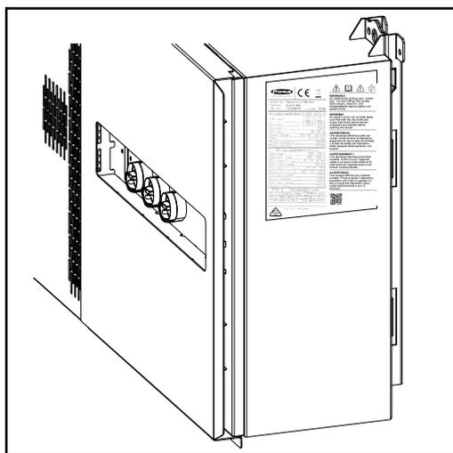
Un numéro à 4 chiffres (coded production date) est imprimé tout en bas de la plaque signalétique. Il est possible de calculer la date de production de l'appareil à partir de ce numéro. Il suffit de soustraire le chiffre 11 aux deux premiers chiffres pour obtenir l'année de production. Les deux derniers chiffres représentent la semaine calendaire au cours de laquelle l'appareil a été produit.
