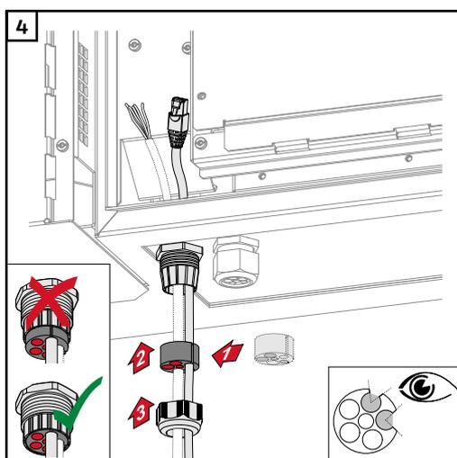
Insérer la bague d'étanchéité entre l'écrou-raccord et l'ouverture du boîtier. Enfoncer le câble de données dans le guide-câble de la bague d'étanchéité. Appuyer ensuite sur le joint jusqu'au bord inférieur de l'anti-traction.
