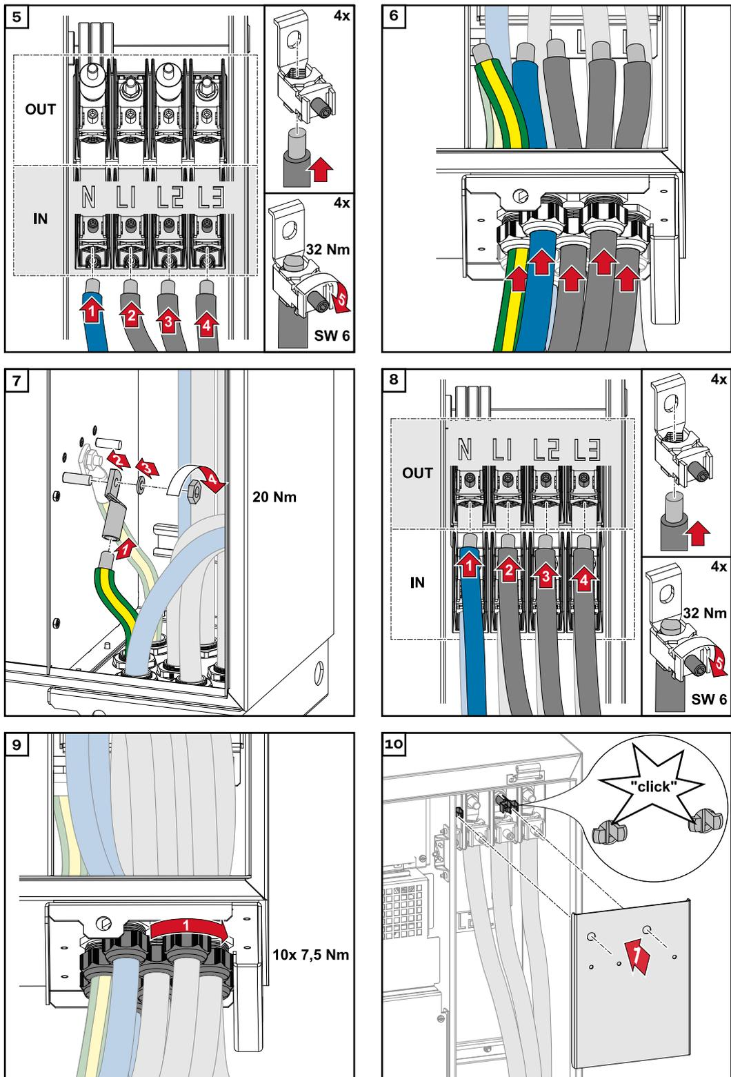
**Raccorder les câbles avec cosse de câble**
