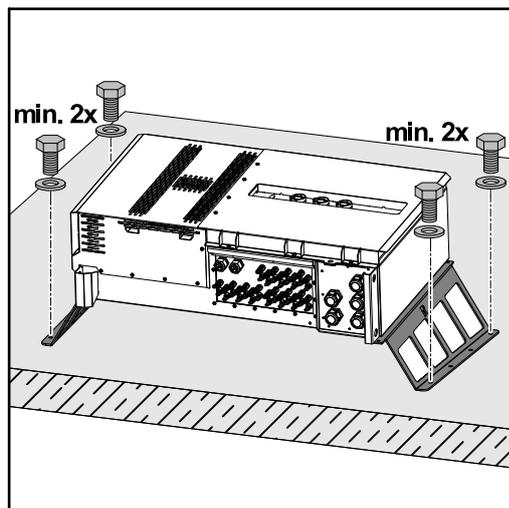
Le montage de l'onduleur sur une surface de montage horizontale n'est pas obligatoire, mais recommandé. En fonction du support de pose, divers types de chevilles et de vis sont nécessaires pour l'installation au sol des Floor Racks. C'est la raison pour laquelle les chevilles et les vis ne sont pas fournies avec l'onduleur. L'installateur est personnellement responsable du choix des chevilles et des vis adaptées.
