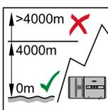
**IMPORTANT !** L'onduleur ne doit pas être monté et mis en service sur un site dont l'altitude est supérieure à 4 000 m.
