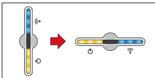
Pour simplifier la lisibilité, la position d'installation verticale du circuit imprimé Pilot (affichage LED) est indiquée horizontalement par la suite.
