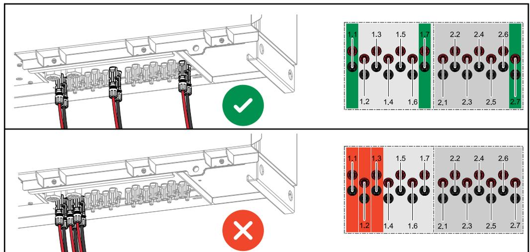
**Connecter le câble PV - connecteur MC4**
