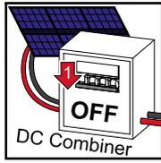
Avant tous travaux dans la zone de raccordement de l'onduleur, la tension DC doit être coupée. Cela peut également être effectué dans le boîtier collecteur DC.
