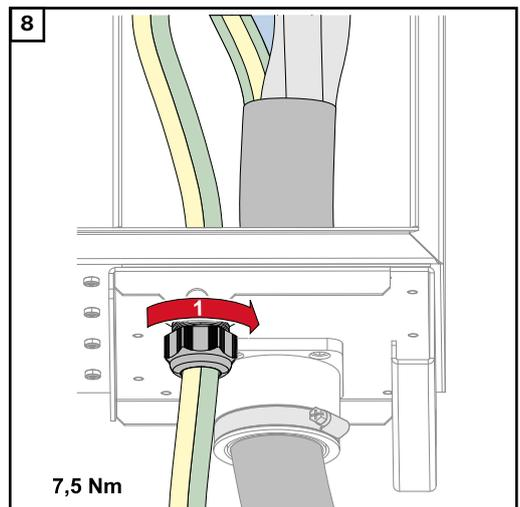
Fixer avec le couple de serrage indiqué par le fabricant
