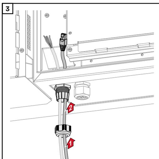
Faire d'abord passer le câble de données par l'écrou-raccord de l'anti-traction, puis par l'ouverture du boîtier.
