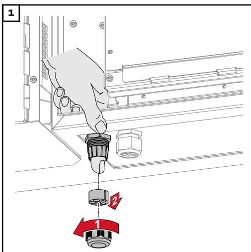
Desserrer l'écrou-raccord de l'anti-traction et dégager la bague d'étanchéité avec les bouchons obturateurs de l'intérieur de l'appareil.
