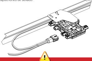
ADVERTENCIA: Instale protectores de sellado en todos los conectores de CA sin uso conforme vayan activándose cuando se energice el sistema. Se necesitan protectores de sellado para la protección contra el ingreso de humedad.
