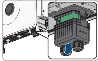
6. Die Überwurfmutter von einer noch nicht verwendeten Kabelverschraubung für Kommunikationskabel abdrehen.
