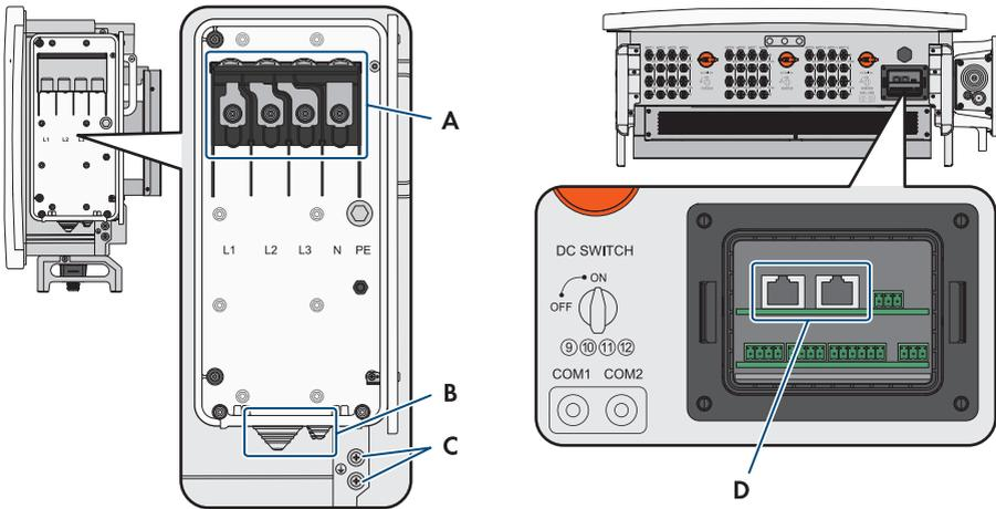
Abbildung 7: Anschlussbereich im Inneren des Wechselrichters
