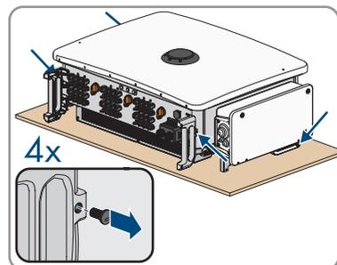
6. Wenn der Wechselrichter mithilfe von Hebezeug in die Montagehalterung eingehängt werden soll, die Ringschrauben in die 2 oberen Gewindebohrungen auf der rechten und linken Seite des Wechselrichters eindrehen und Hebezeug daran befestigen. Dabei muss sich das Hebezeug für das Gewicht des Wechselrichters eignen.
