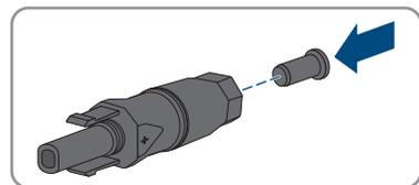
9. Die DC-Steckverbinder mit Dichtstopfen in die zugehörigen DC-Eingänge des Wechselrichters stecken.
