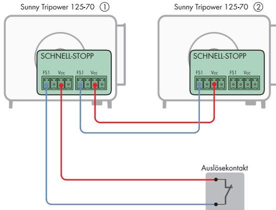
Abbildung 9: Verschaltungsübersicht für den Anschluss eines Kontakts für den Schnell-Stopp und der Verbindung mehrerer Wechselrichter
