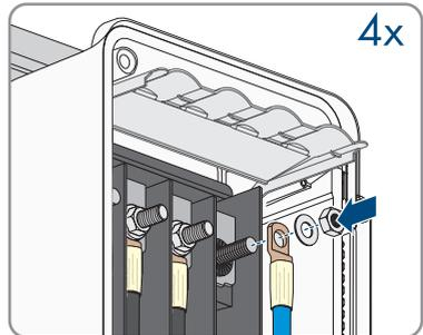
12. PE auf den Gewindebolzen (M8, Drehmoment: 20 Nm bis 30 Nm) im mittleren Bereich mit 1 Unterlegscheibe und Sechskantmutter setzen und mit Hilfe einer Ratsche festdrehen.
