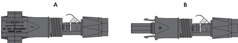
Abbildung 11: Negativer (A) und positiver (B) DC-Steckverbinder
