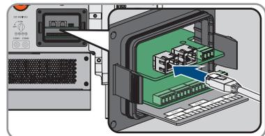
9. Sicherstellen, dass der RJ45 Stecker fest sitzt und keine Zugspannung auf dem Kabel liegt.
