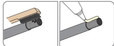
7. Die Dichtungsplatte des AC-Anschlusses an der Unterseite des Wechselrichters entsprechend des Durchmessers des Kabels zuschneiden.
