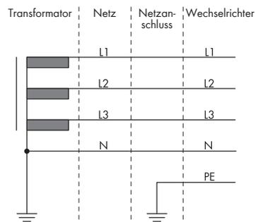
Abbildung 5: Übersicht der zugelassenen Netzformen
