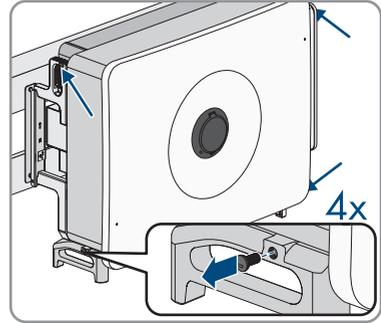
2. Alle 4 Transportgriffe oder die Ringschrauben des Hebezeugs in die Gewindebohrungen drehen.
