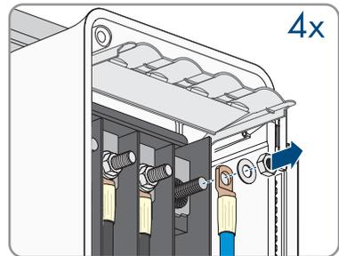
6. Den PE-Leiter mit Ringkabelschuh mit Hilfe einer Ratsche lösen.
