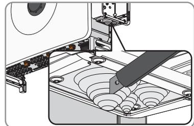
8. Das Kabel durch die Dichtungsplatte in das Gerät führen.
