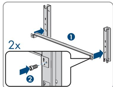
2. Die Montagehalterung mithilfe einer Wasserwaage ausrichten und Bohrpositionen markieren.
