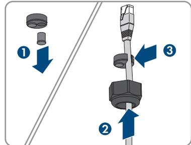
7. Die Zweiloch-Kabeltülle mit dem Kabel in die Kabelverschraubung drücken und das Netzkabel zum RJ45-Anschluss im unteren Bereich des Kabelfachs führen. Dabei sicherstellen, dass die ungenutzte Kabeldurchführung der Zweiloch-Kabeltülle mit einem Dichtstopfen verschlossen ist.
