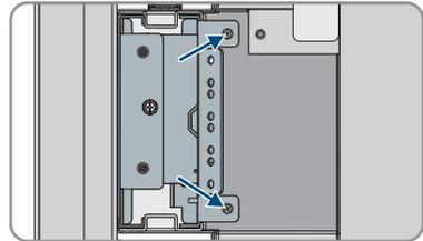
7. Die Lüfterkassette aus dem Wechselrichter ziehen.
