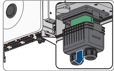
12. Alle Anschlusskabel von der Kommunikationsbaugruppe entfernen.
