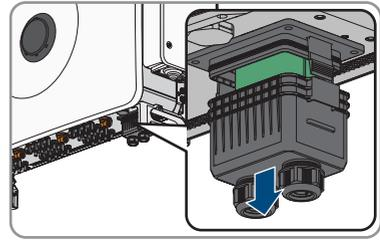
2. Die Überwurfmutter von einer der beiden Kabelverschraubungen für Kommunikationskabel abdrehen.
