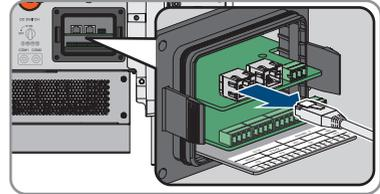
13. Anschlusskabel aus der Kabelverschraubung nehmen.
