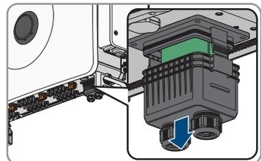
5. Die Überwurfmutter von einer der beiden Kabelverschraubungen für Kommunikationskabel abdrehen.
