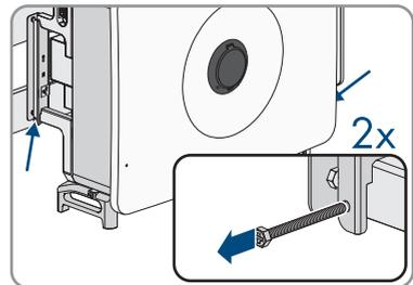
6. Den Wechselrichter aus der Montagehalterung hängen.
