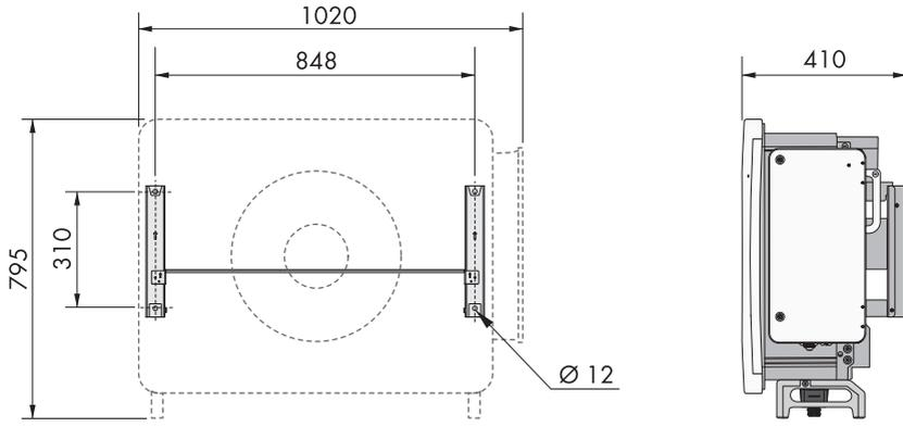
Abbildung 4: Bemaßung der Montagehalterung (Maßangaben in mm)
