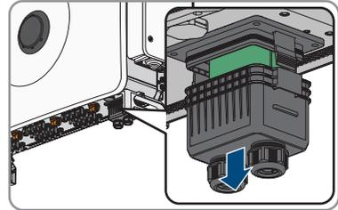
3. Die Überwurfmutter von einer der beiden Kabelverschraubungen für Kommunikationskabel abdrehen.
