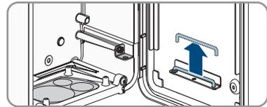
4. Das Ende des Begrenzungshebels im Kabelfach auf dem Gewinde einrasten.
