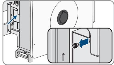
4. Die Dichtungsplatte der Lüfterkassette abnehmen.
