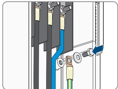
13. Sicherstellen, dass das AC-Kabel nicht unter Zug steht.
