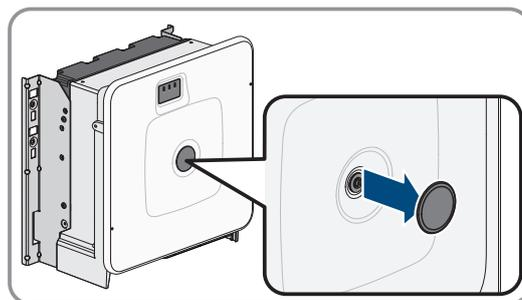
9. Dévissez la vis du couvercle du boîtier (clé pour vis à six pans creux, SW8) et retirez le couvercle du boîtier.
