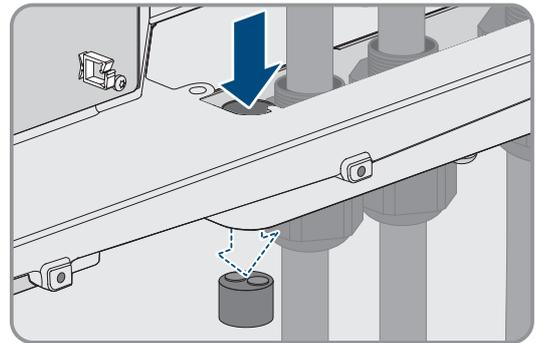
5. Sur chaque câble réseau, retirez un bouchon d'une ouverture de boîtier et entaillez l'ouverture correspondante pour chaque câble réseau à l'aide d'un cutter.
