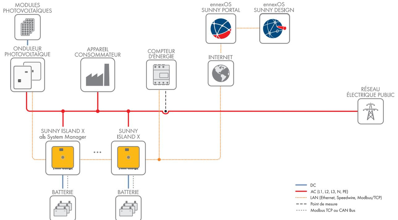
Figure 2 : Sunny Island X comme System Manager dans un système fonctionnant sur le réseau électrique public (exemple)
