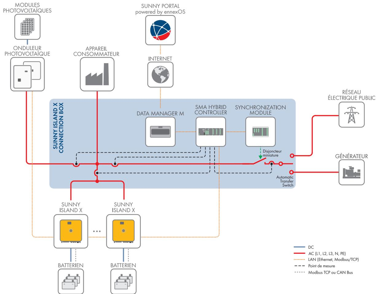
Figure 6 : SMA Hybrid Controller comme System Manager dans un système fonctionnant sur le réseau électrique public et avec générateur (exemple)
