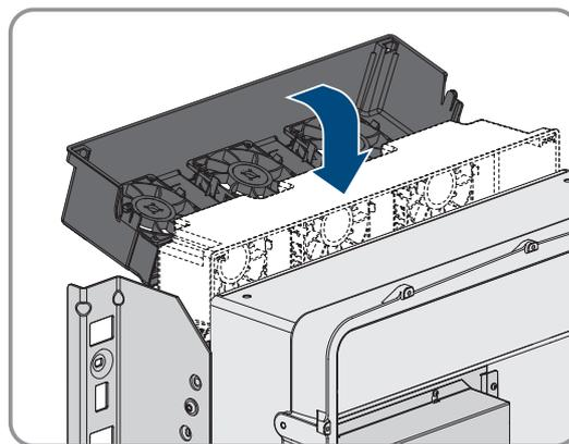
7. Guidez le support des ventilateurs vers le bas et l'insérez à la verticale dans les supports de boîtier prévus à cet effet.
