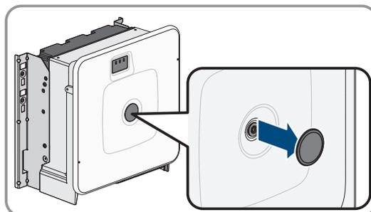
5. Dévissez la vis du couvercle du boîtier (clé pour vis à six pans creux, SW8) et retirez le couvercle du boîtier.
