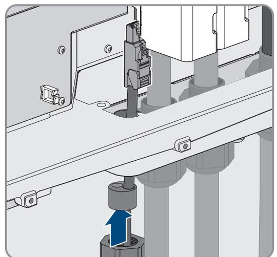
9. En cas d'utilisation de câbles à confectionner soi-même : raccordez les connecteurs RJ45 conformément à l'affectation des broches prescrite et au câble.
