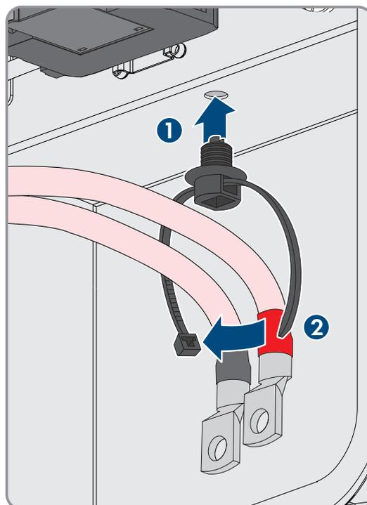
7. Montez l'appareil de remplacement et réalisez le raccordement électrique comme décrit dans ce document. Utilisez pour cela la plaque de raccordement et les dispositifs de protection contre les surtensions du produit défectueux.
