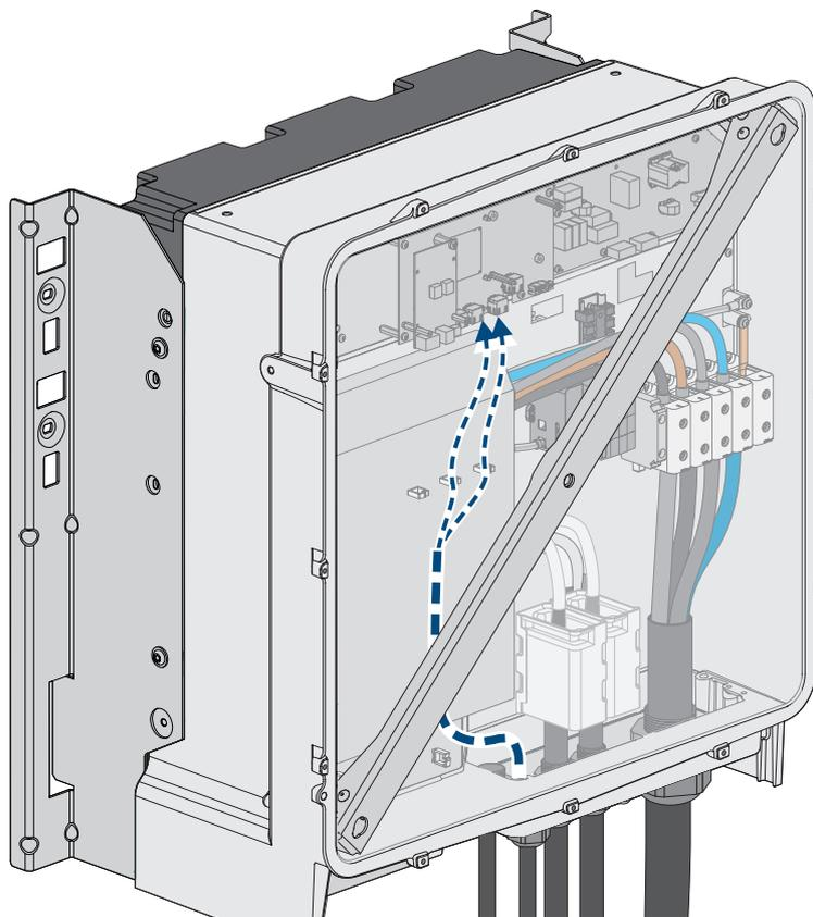
Figure 15 : Vue intérieure de l'onduleur avec plan de pose pour le câble réseau/câble de communication avec la batterie
