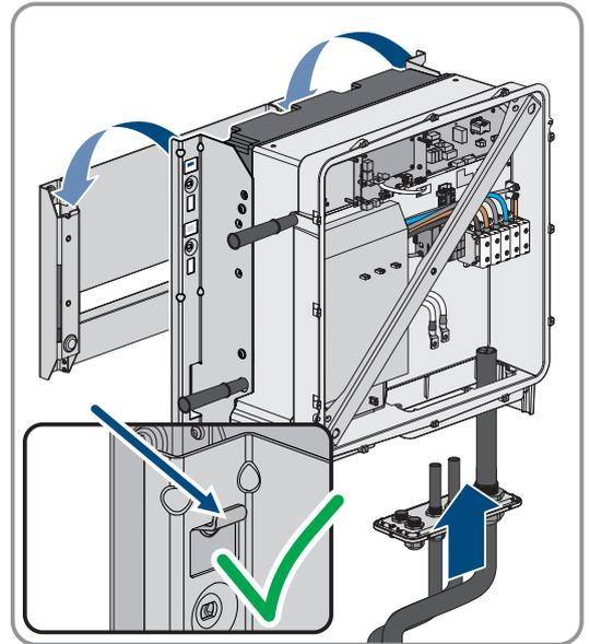
8. Alignez les câbles à l'aide du gabarit de montage et les raccourcir si nécessaire. Prenez en compte la profondeur du produit de 400 mm.
