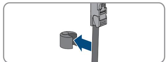
7. Pressez le manchon support de câble à deux orifices dans le presse-étoupe et guidez chaque câble réseau vers la prise réseau. Ce faisant, disposez les câbles selon le plan de pose et fixez-les aux supports.
