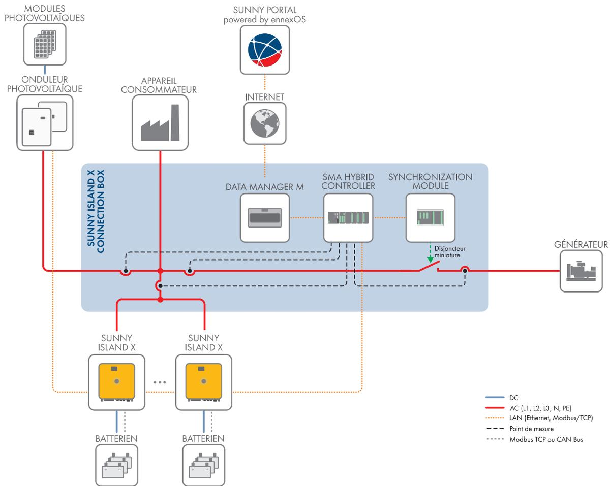
Figure 4 : SMA Hybrid Controller comme System Manager dans un système avec un générateur (exemple)
