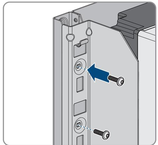
10. Dévissez les quatre poignées de transport des trous filetés. Au besoin, insérez un tournevis dans les trous des poignées de transport pour les dévisser.
