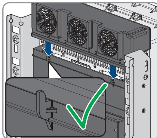
8. Poussez fermement le support du ventilateur vers le haut de manière à ce que les ergots d'enclenchement s'engagent à droite et à gauche.
