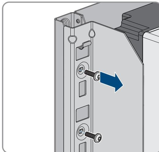
5. Retirez le produit par le haut des attaches de suspension des supports de montage.
