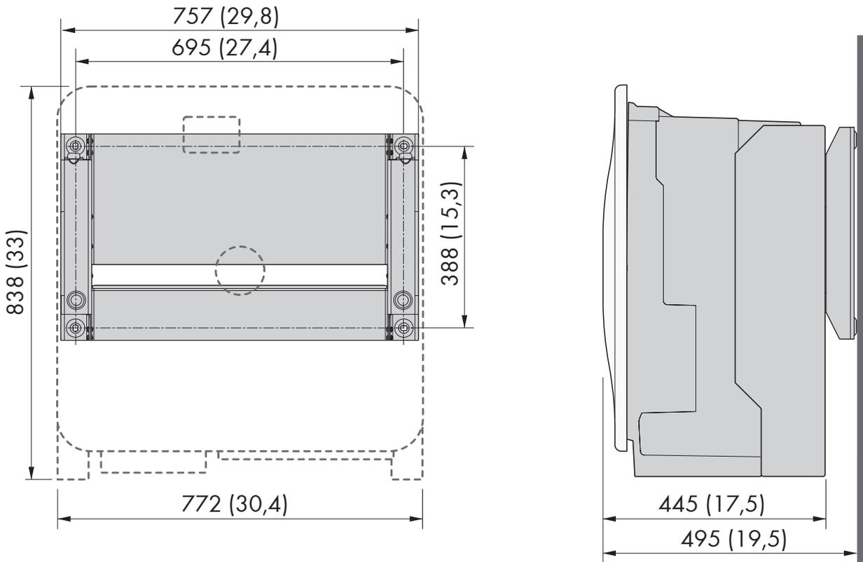
Figure 11 : Position des points de fixation (dimensions en mm (in))
