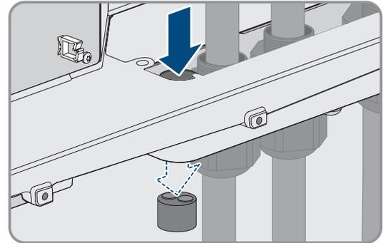
6. Sur le câble de communication avec la batterie, retirez un bouchon d'une ouverture de boîtier et entaillez l'ouverture correspondante pour ce câble à l'aide d'un cutter.
