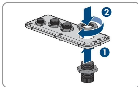
9. Passez les câbles au travers des presse-étoupes dans la plaque de raccordement et alignez la plaque de raccordement à l'aide du gabarit de montage.
