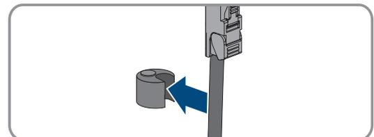
8. Enfoncez le manchon support de câble à deux orifices dans le presse-étoupe et guidez le câble de communication avec la batterie vers l'embase **BAT ETH**. Ce faisant, disposez le câble de communication avec la batterie selon le plan de pose et fixez-le aux supports.
