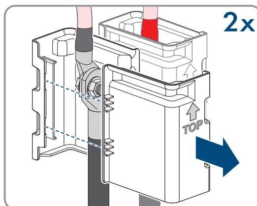
4. Retirez la connexion du câble DC. Desserrez pour cela les écrous à six pans (surplat 10) et retirez les vis à six pans combinées (surplat 16).
