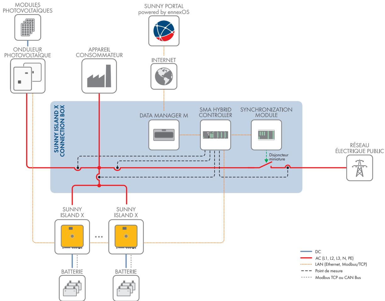
Figure 5 : SMA Hybrid Controller comme System Manager dans un système fonctionnant sur le réseau électrique public (exemple)
