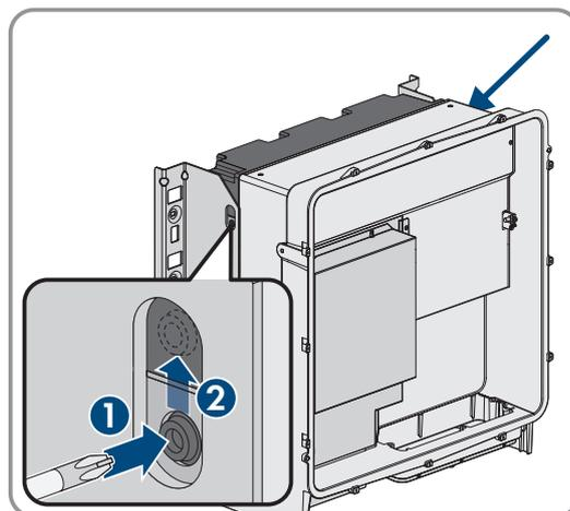
3. Guidez le support des ventilateurs vers le haut et rabattez-le en arrière. Veillez pour cela à ce que le support des ventilateurs ne puisse pas être entièrement retiré, puisqu'il est relié au produit par le câble du ventilateur.
