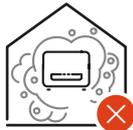
Der Wechselrichter ist staubdicht (IP 66) ausgeführt. In Bereichen mit starker Staubansammlung können sich Staubablagerungen auf den Kühlflächen ansammeln und somit die thermische Leistungsfähigkeit beeinträchtigen. In diesem Fall ist eine regelmäßige Reinigung erforderlich. Eine Montage in Räumen und Umgebungen mit starker Staubentwicklung ist daher nicht zu empfehlen.
