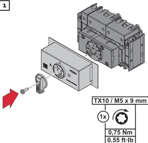
Montare il coperchio del corpo esterno e l'interruttore e fissarli con la vite.
