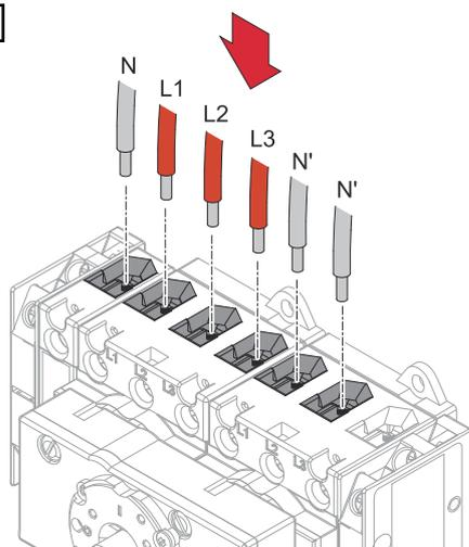
Inserire i singoli conduttori (L1, L2, L3) che partono dalla rete e il conduttore neutro (N) che parte dalla rete nei morsetti. Inserire i due conduttori neutri (N') del circuito di alimentazione di backup nei morsetti.
