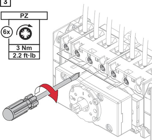
Avvitare i singoli conduttori (L1, L2, L3) e il conduttore neutro (N) nei morsetti. Avvitare i due conduttori neutri (N') nei morsetti. Per le viti di collegamento e le coppie di serraggio consentite, vedere **Viti di collegamento consentite** a pagina **19**.
