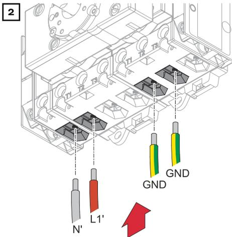
Inserire il singolo conduttore (L1') che parte dal circuito di alimentazione di backup e il conduttore neutro (N') che parte dal circuito di alimentazione di backup nei morsetti. Inserire i cavi di messa a terra (GND) del cablaggio domestico nei morsetti.
