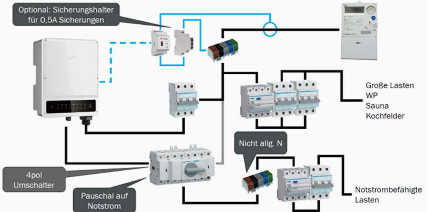
Für Wartungsarbeiten oder bei einem Defekt des Wechselrichters empfehlen wir die Installation eines manuellen allpoligen Umschalters, um in so einem Fall die Notstromlasten auf normalen Netzbetrieb umschalten zu können.
