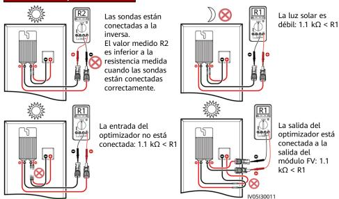
3. Compruebe que la entrada del optimizador esté conectada correctamente y conecte los cables de potencia de salida al optimizador. Mida la resistencia de la cadena fotovoltaica cuando haya suficiente luz solar.
