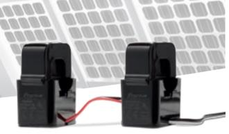
Durch die einfache Split-Core-Technologie kann ein Ende der Stromwandler (Fronius Smart Meter CT A und Fronius Smart Meter CT V) abgenommen werden, ohne dass das Kabel für die Installation abgeklemmt werden muss. So können die Fronius Stromwandler einfach und schnell installiert werden.
