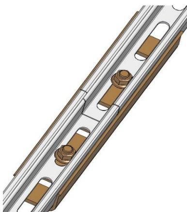
Empalmar firmemente los extremos de los raíles, colocar el conector de raíl en el centro y unirlos al raíl con los tornillos de fijación que se incluyen en el set. El conector y la cantidad de tornillos dependen del raíl (VM 1.1). La longitud máxima de los raíles sin interrupción es de 13 m; a continuación, se debe instalar una junta o hueco de dilatación (VM 1.3).
