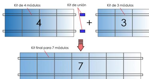
Para realizar una fila de 10 módulos se realizaría con 1 kit de 4 + 1 Kit de 6 + 1 Kit de unión.
