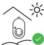
Le Wattpilot est adapté à un fonctionnement en extérieur sans rayonnement solaire direct.
