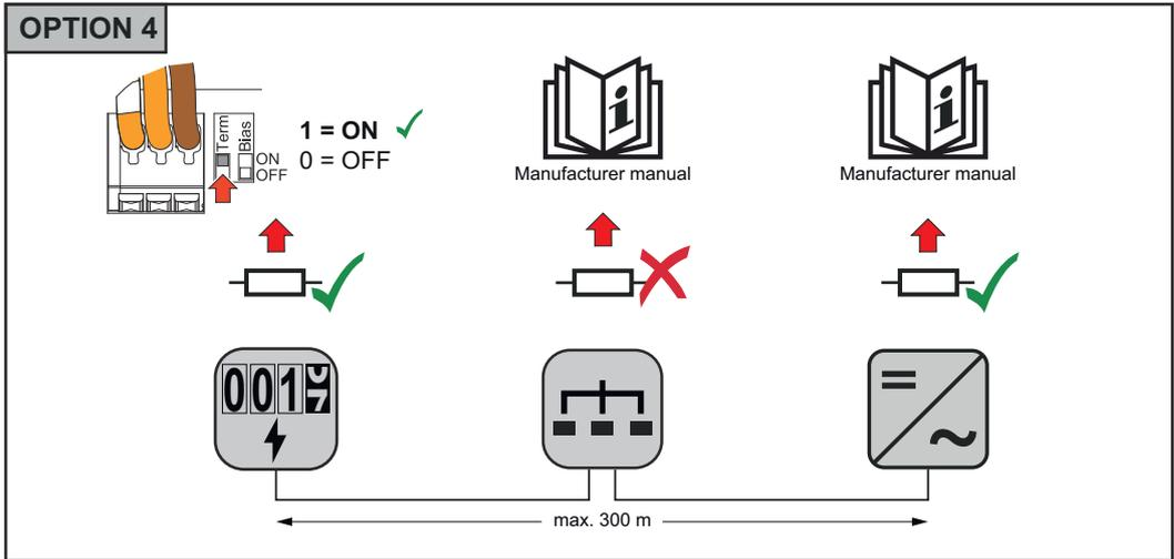
**Modbus RTU BI-AS setzen**
