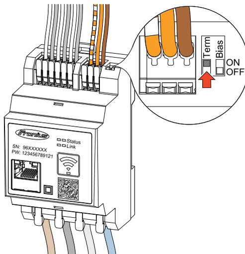
Der Abschluss-Widerstand ist im Fronius Smart Meter IP integriert und wird per Schalter gesetzt.
