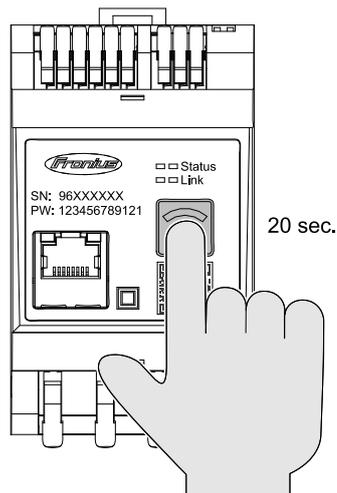
Wenn die Taste **WLAN Accesspoint und Reset** 20 Sekunden lang gedrückt wird, wird ein Werksreset des Fronius Smart Meters IP durchgeführt. Alle LEDs am Fronius Smart Meter IP erlöschen und das Gerät bootet neu (kann einige Minuten dauern).
