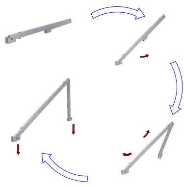
*Apriete de las uniones y anclaje al suelo mediante tornillo de hasta M10*
