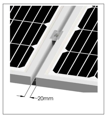
Introducir la parte inferior del presor en el perfil G48 y alinear salientes del presor en la ranura del perfil.
