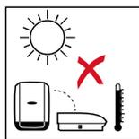
Para que el inversor se caliente lo menos posible, no debe exponerse a la radiación solar directa. Montar el inversor en una posición protegida, por ejemplo, en la zona de los módulos solares o debajo de un saliente de tejado.
