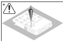
Al abrir los puntos de rotura nominales en el lado posterior, se debe apoyar el soporte mural con el lado posterior orientado hacia arriba sobre una superficie nivelada, para que así las virutas y piezas metálicas puedan caer fuera del soporte mural.
