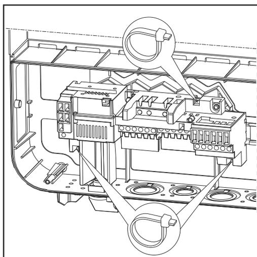
Si hay que instalar cables CA o CC con sobrelongitud en la zona de conexión, utilizar una sujeción de cables para fijar los cables en los ojales previstos en los lados superior e inferior del bloque de conexión.
