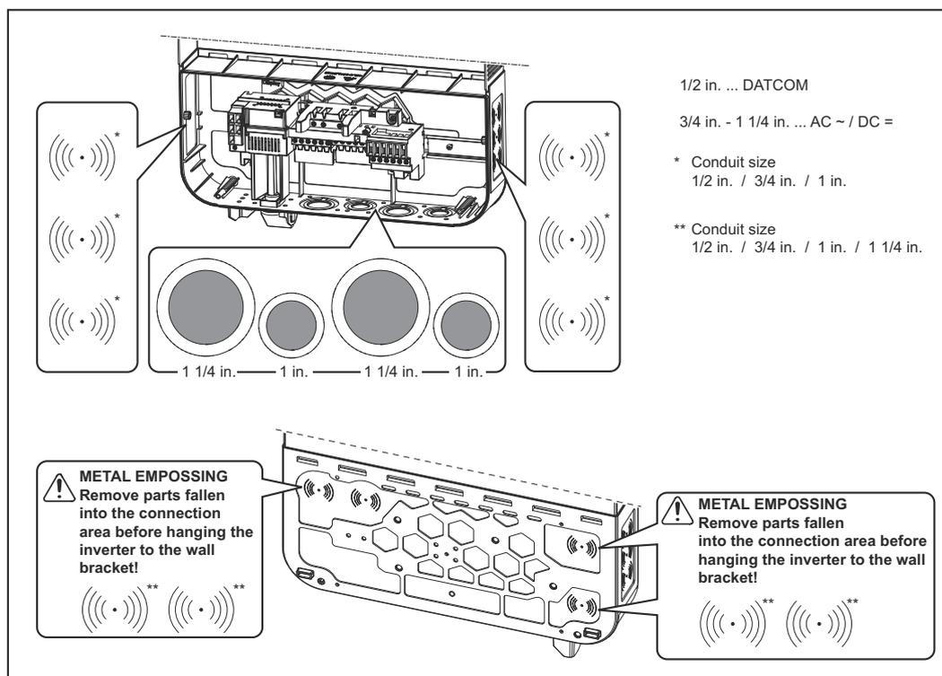
El soporte mural dispone de varios puntos de rotura nominales de diferente tamaño. Después de romper estos puntos, se producen escotaduras que sirven de entrada para los cables más diversos:
