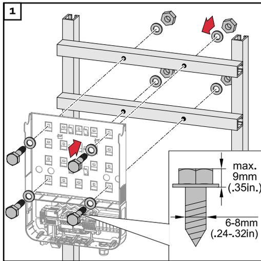
**Evitar la torsión o deformación del soporte de fijación**
