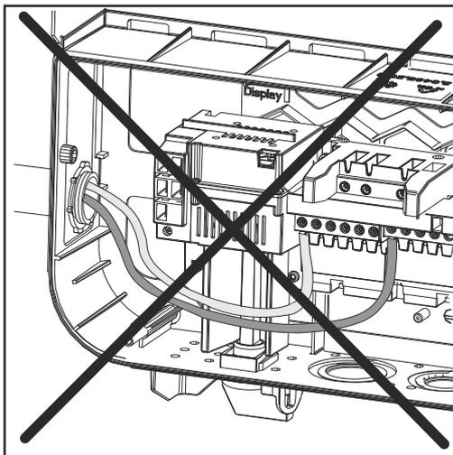
Si los cables CA se instalan a través del eje del interruptor principal CC o transversalmente sobre el bloque de conexión del interruptor principal CC, estos elementos se pueden dañar cuando el inversor gira hacia dentro, o puede ocurrir que no se pueda virar el inversor hacia dentro.
