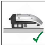
El inversor resulta adecuado para el montaje horizontal.
