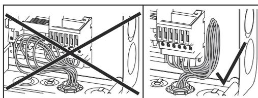
Si se instalan los cables CA a través del eje del interruptor principal CC o transversalmente por encima del bloque de conexión del interruptor principal CC, estos elementos pueden sufrir daños cuando el inversor gire hacia dentro, o puede ocurrir que no sea posible virar el inversor hacia dentro.
