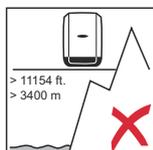
**¡IMPORTANTE!** No se debe montar ni utilizar el inversor a una altura superior a 11154 ft. (3400 m) sobre el nivel del mar.
