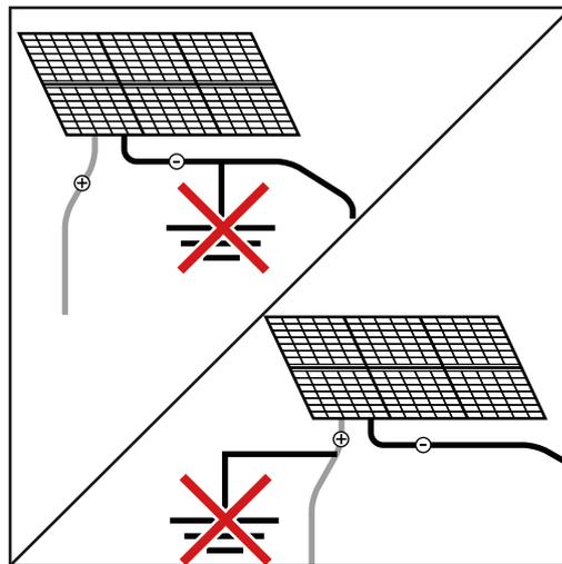
El inversor ha sido concebido exclusivamente para la conexión y la utilización con módulos solares no conectados a tierra. Los módulos solares no se deben conectar a tierra, ni en el polo positivo ni en el polo negativo.
