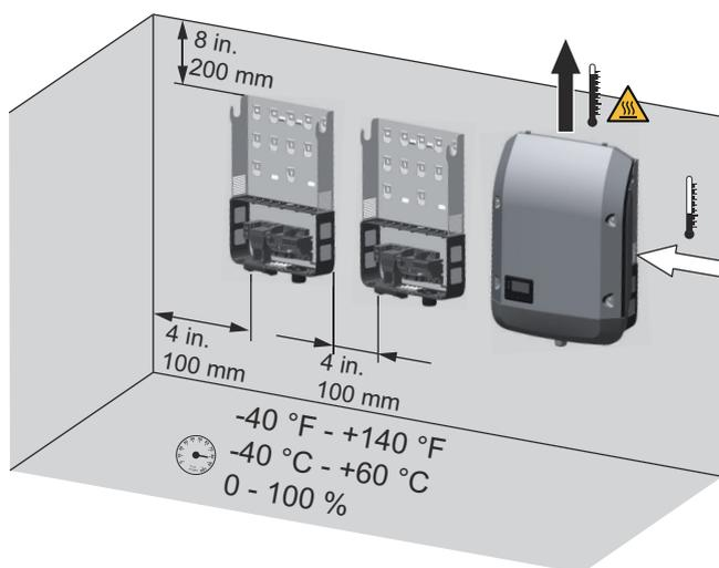
Realizar la instalación solo sobre una base firme y que no sea inflamable
