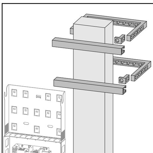
Para el montaje del inversor en un poste o soporte, Fronius recomienda el kit de fijación en postes "Pole clamp" (número de pedido SZ 2584.000) de la empresa Rittal GmbH.
