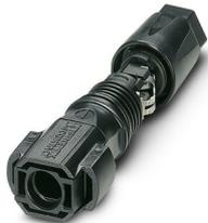
Conector enchufable fotovoltaico, Familia de artículos: Sunclix, Conector, material carcasa: PPE, color: negro, número de polos: 1, sección mín. de conductor: 2,5 mm<sup>2</sup>, sección máx. de conductor: 6 mm<sup>2</sup>, tensión de dimensionamiento: 1100 V DC, corriente asignada: 35 A, Tipo de conexión: Por resorte, Tipo de contacto: Pin, diámetro de cable mín.: 5,5 mm, diámetro de cable máx.: 8 mm. Artículos siguientes a partir de 1774687
