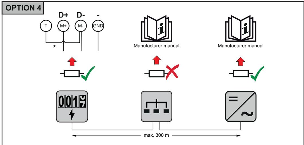
\* Der Abschluss-Widerstand beim Fronius Smart Meter TS wird mit einer Drahtbrücke zwischen **M-** und **T** hergestellt.
