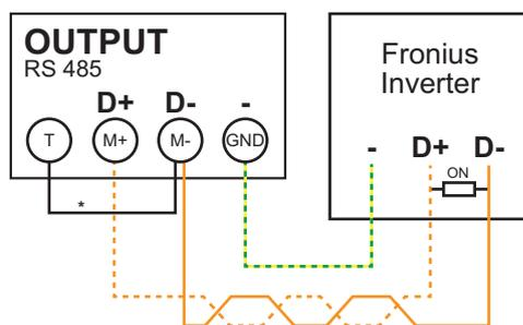
\* Für die Vermeidung von Interferenzen muss der Abschluss-Widerstand (siehe Kapitel [Abschluss-Widerstände](#) auf Seite 23) verwendet werden. Dieser ist im Fronius Smart
