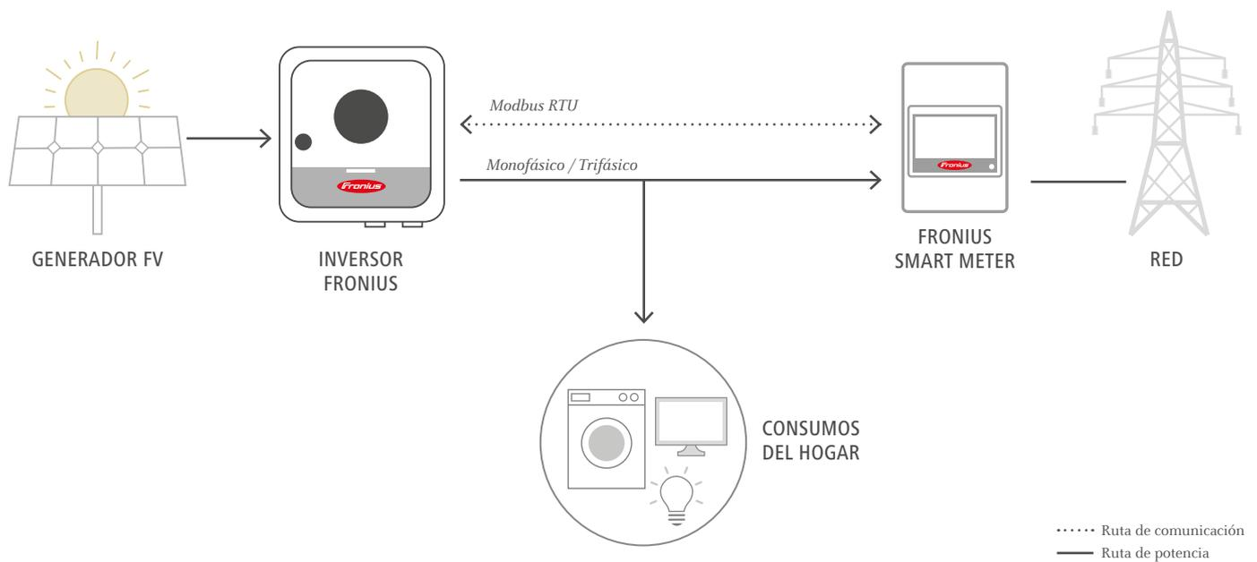
El Fronius Smart Meter es compatible con todos los inversores con un Interface RS485 (Modbus RTU). También puede ser instalado en cualquier momento junto con el Fronius Datamanager 2.0, después de la puesta en marcha de un inversor.
