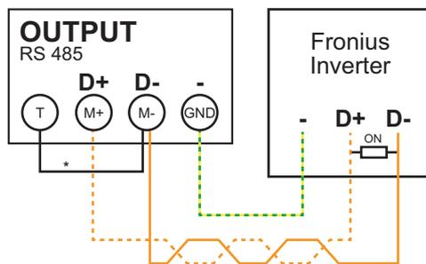
\* Für die Vermeidung von Interferenzen muss der Abschluss-Widerstand (siehe Kapitel **Abschluss-Widerstände** auf Seite 20) verwendet werden. Dieser ist im Fronius Smart Meter TS integriert und muss mit einem Draht zwischen **M-** und **T** (T = Terminierung) hergestellt werden.
