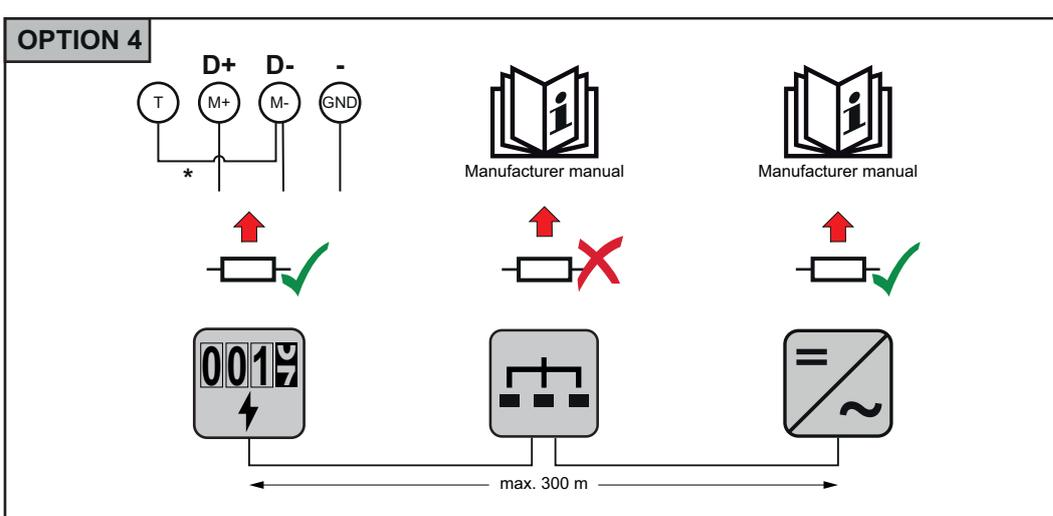
\* Der Abschluss-Widerstand beim Fronius Smart Meter TS wird mit einer Drahtbrücke zwischen **M-** und **T** hergestellt.
