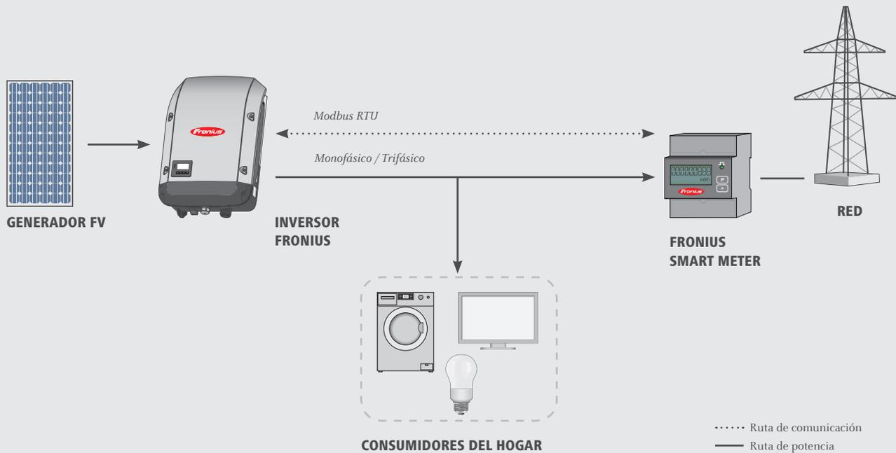
/ El Fronius Smart Meter es compatible con todos los inversores con un Interface RS485 (Modbus RTU). Para los inversores Fronius IG<sup>1)</sup>, Fronius IG Plus y Fronius CL, funciona con el Fronius Datamanager 2.0 mientras que para el Fronius IG TL, Fronius Agilo y Fronius Agilo TL es necesario utilizar el Fronius Datamanager Box 2.0. El Fronius Smart Meter puede ser instalado en cualquier momento junto con el Fronius Datamanager 2.0, después de la puesta en marcha de un inversor.
