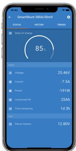
El SmartShunt es un monitor de batería todo en uno pero sin pantalla. Utiliza la pantalla de su teléfono.
