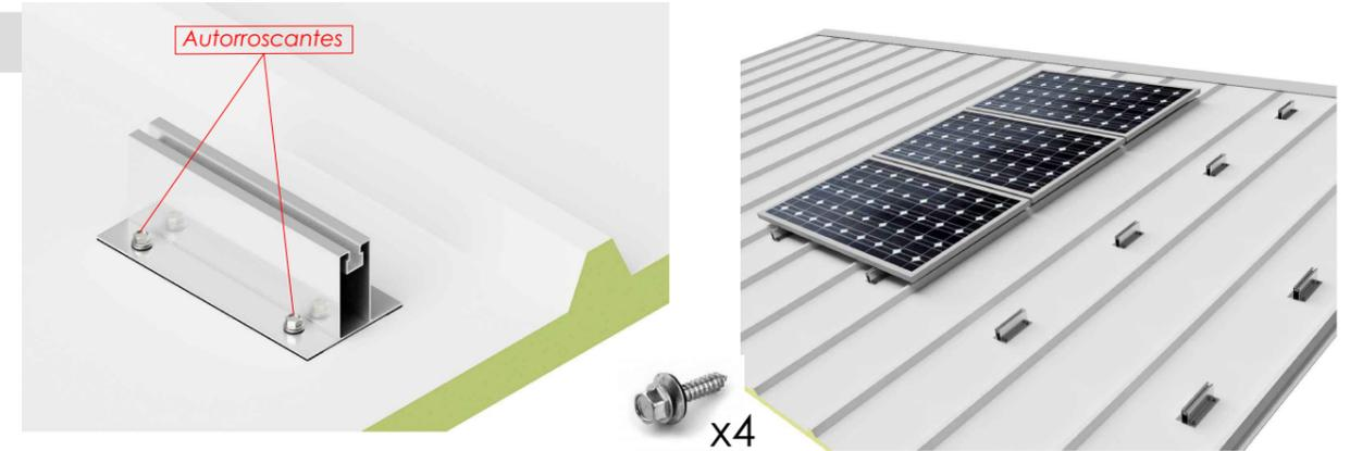
El perfil se fija a la chapa sandwich mediante 4 tornillos autorroscantes (2 a cada lado)
