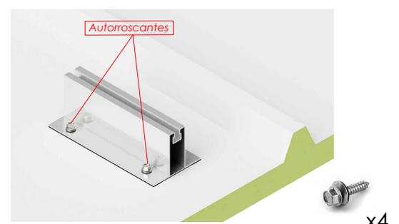
El perfil se fija a la chapa sandwich mediante 4 tornillos autorroscantes (2 a cada lado).
