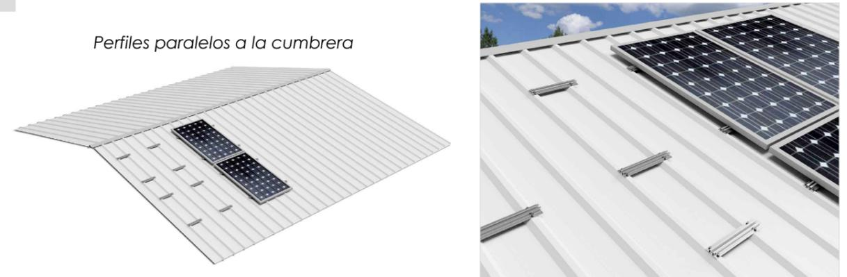
El perfil se fija a la chapa mediante 4 tornillos autorroscantes (2 a cada lado)
