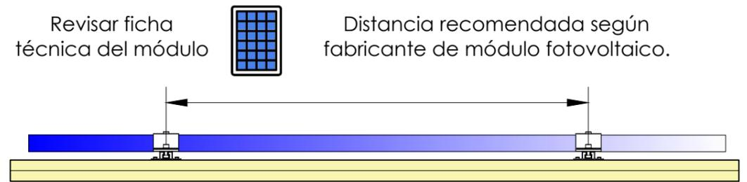
**Fijación de los módulos con los presores centrales y laterales**
