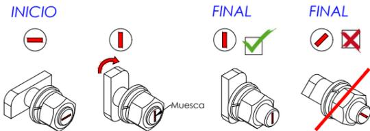
Colocar el tornillo martillo (muesca del tornillo en horizontal en el interior del perfil por la guía estrecha. Girar a la derecha hasta su tope (muesca del tornillo en vertical)
