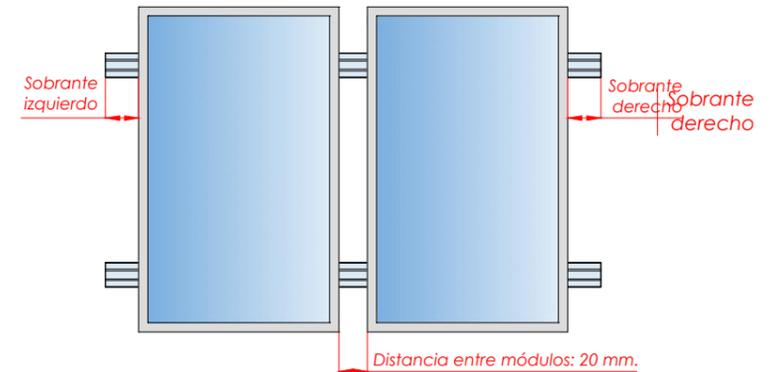
Dejar una separación entre módulos de 20 mm para poner el presor central que fijará los módulos al perfil.
