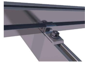
Detalle fijación G1 a triángulo
