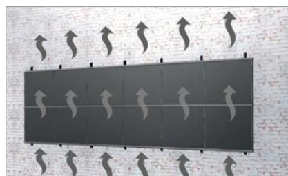
Sehr gute Hinterlüftung der Module
